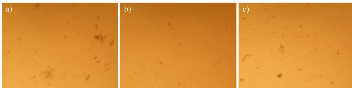
Slika 71. Snimke svjetlosnim mikroskopom uzorka u uzv sustavu: c(\text{citrat})/ \text{mmol dm}^{-3} = 0,0 omjera c(\text{Ca}^{2+})/c(\text{C}_2\text{O}_4^{2-}) : a) 3,86, b) 8,23 i c) 16,0.
