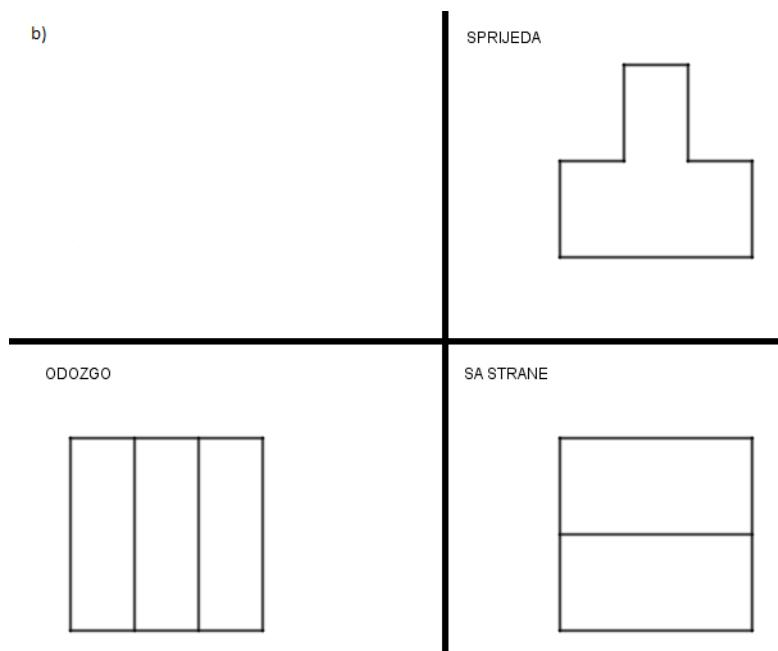
Slika 1.13: Tlocrt, bokocrt i nacrt geometrijskog tijela
