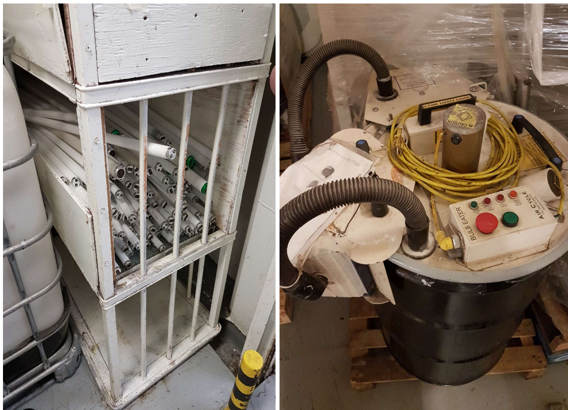
Slika 4.11. Fluorescentne žarulje (lijevo), uređaj za njihovo usitnjavanje u prah (desno); fotografija: Nikola Marvučić
