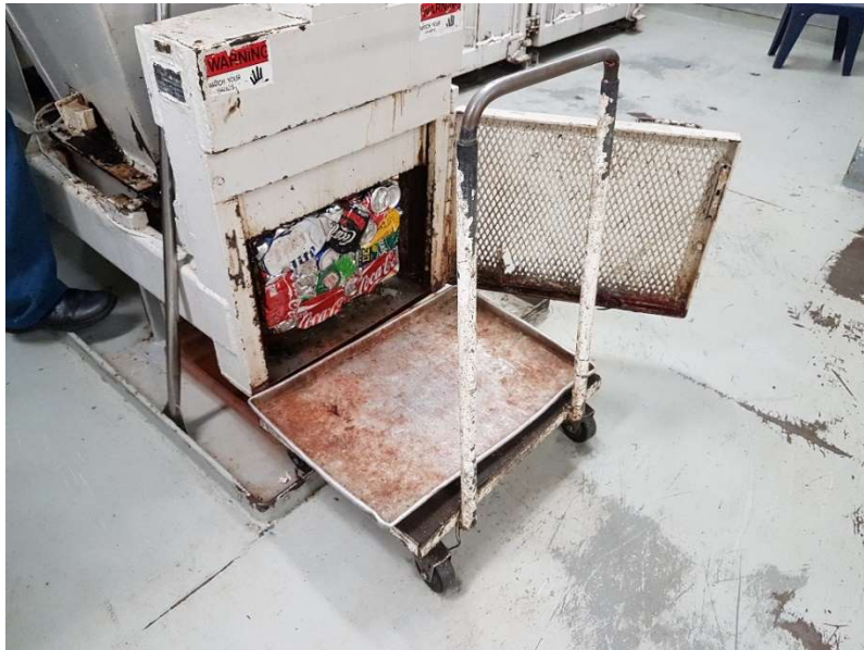
Slika 4.15. Uređaj za prešanje limenki; fotografija: Nikola Marvučić
