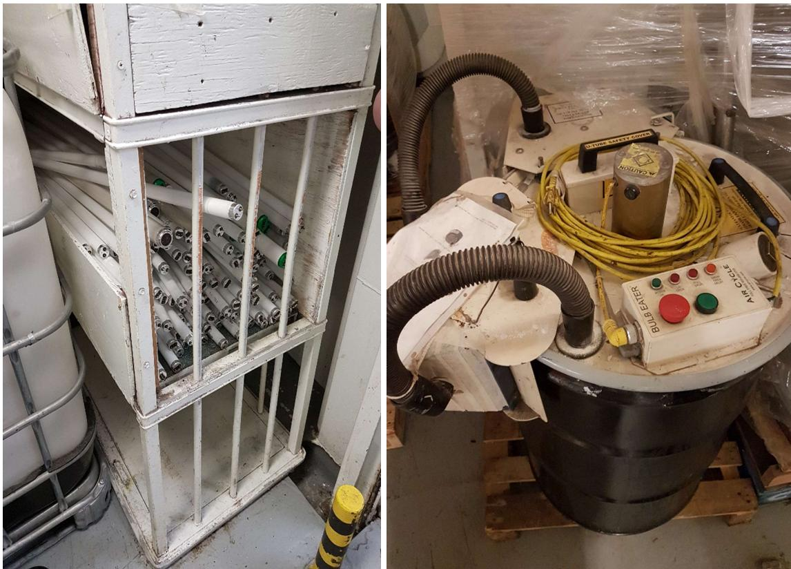
Slika 4.11. Fluorescentne žarulje (lijevo), uređaj za njihovo usitnjavanje u prah (desno);
