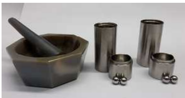
Slika 34. Pribor za mehanokemijsku sintezu
