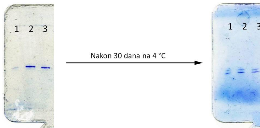
Slika 4.7. Analiza proteinskih frakcija IEF-om odmah nakon pročišćavanja BtDPP III anionskom izmjenom, te nakon 30 dana stajanja na 4 °C. 1-3 – proteinske frakcije od 34 do 36.
