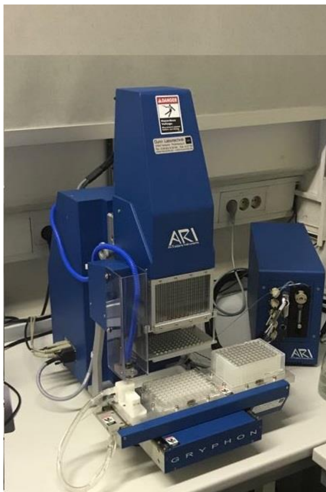
Slika 8. Robot za automatsko postavljanje kristalizacija tj. kristalizacijskih uvjeta ( Crystal Gryphon , Art Robbins Instruments, Institut „Jožef Stefan“, Ljubljana)
