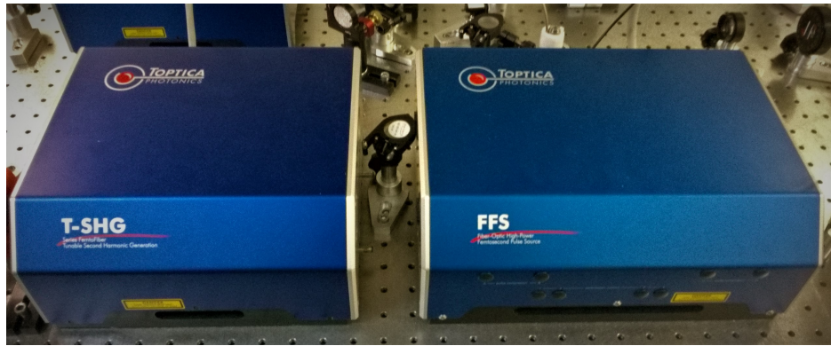
Slika 3.1: Femtosekundni laser (desno) i jedinica za generiranje drugih harmonika (lijevo).
