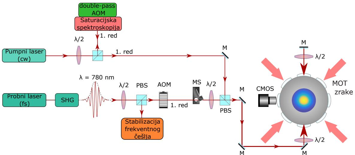
Slika 3.4: Shema eksperimentalnog postava dovođenje pumpnog i probnog lasera do oblaka hladnih atoma. Oznake: PBS - polarizacijski djelitev zrake, M - zrcalo,  $\lambda/2$ ,  $\lambda/4$  - polarizacijske pločice, AOM - akusto-optički modulator, SHG - generator drugog harmonika, MS - mehanički zatvarač, CMOS - kamera. Prilagođeno po uzoru na [22].
