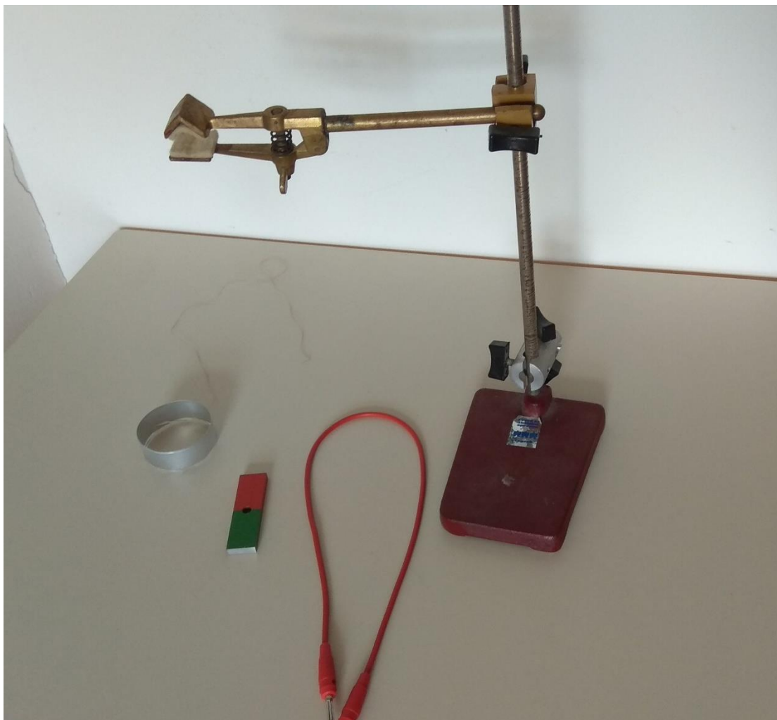
Slika 3.12. Eksperimentalni postav za demonstraciju Lenzovog pravila
