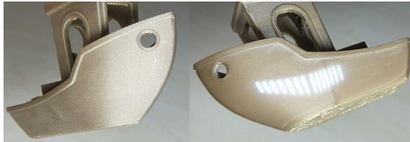
Slika 13: PLA plastika prije i nakon mehaničke obrade.
