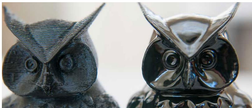
Slika 14: ABS plastika prije i nakon izlaganju acetonskim parama.
