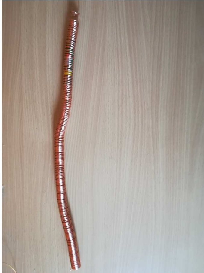
Slika 5.12: Kretanje baterije s magnetima kroz namotanu, bakrenu žicu
