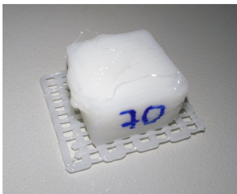
Slika 2.4. Model sa 70% ispune. Ispisivanje je prekinuto.
