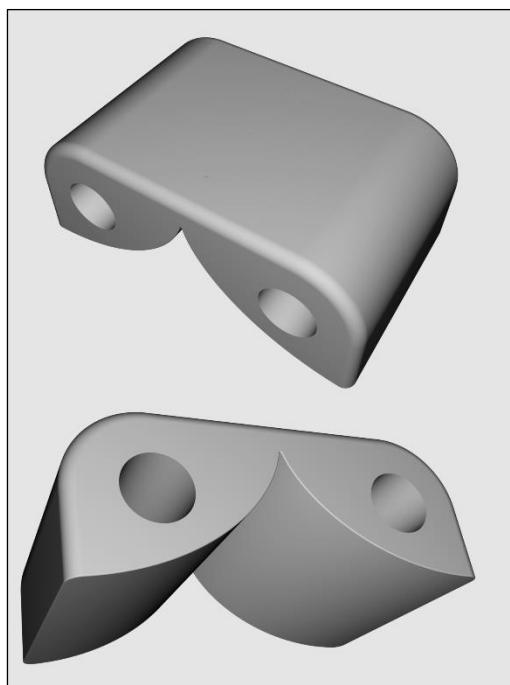
*slika 14.* prikaz nosača njihala iz programa SOLIDWORKS
