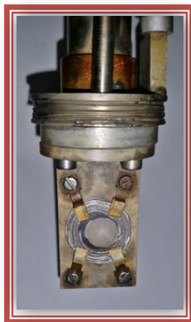
Slika 45. Nosač pričvršćen na glavu kriostata s uzorkom dimera učvršćenog između dviju pločica cezijevo jodida.
