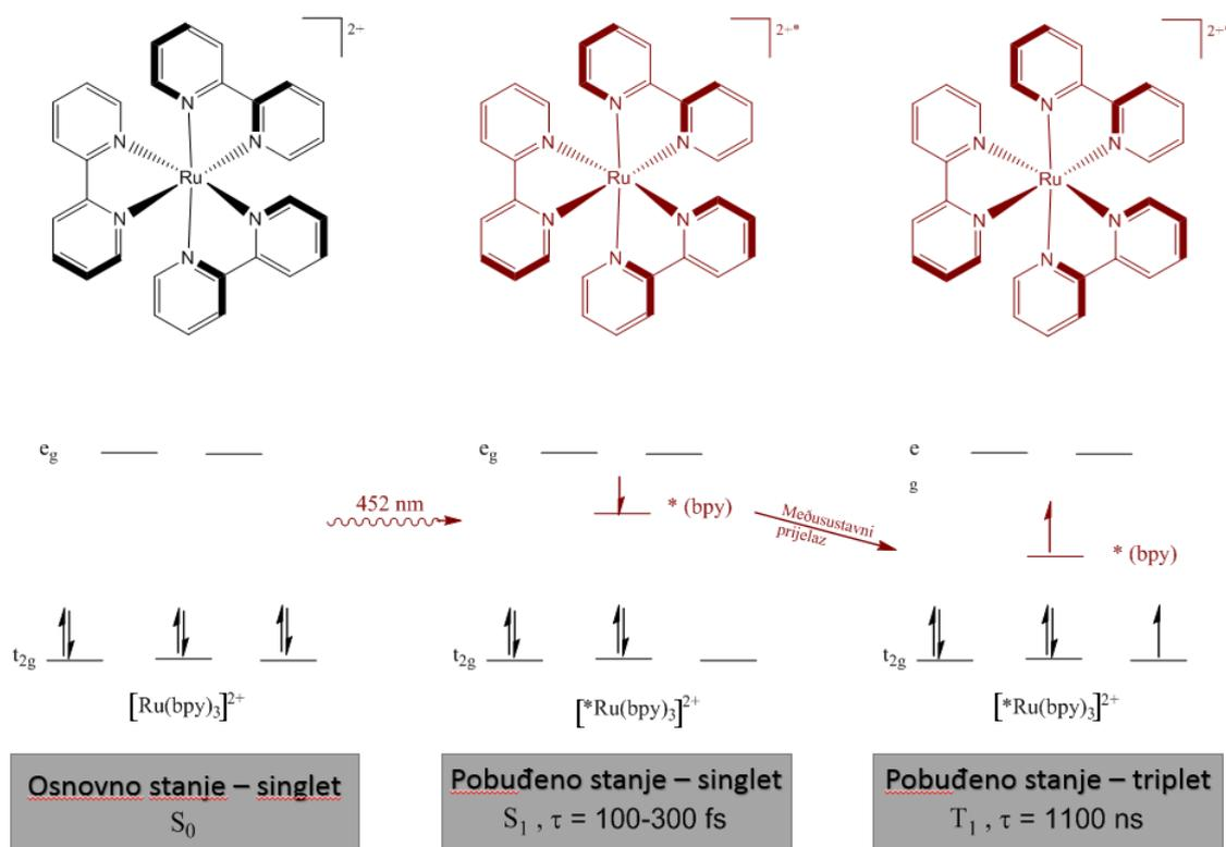
Slika 5. Shematski prikaz apsorpcije fotona i nastanka pobuđenog stanja kod kompleksnog kationa [Ru(bpy)<sub>3</sub>]<sup>2+</sup>
