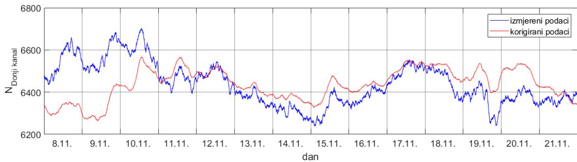
Slika 27. Grafovi izmjereno (plavo) i korigiranog (crveno) intenziteta zračenja za dvotjedni period od 8.11.2010. do 21.11.2010. za donji kanal detektora.
