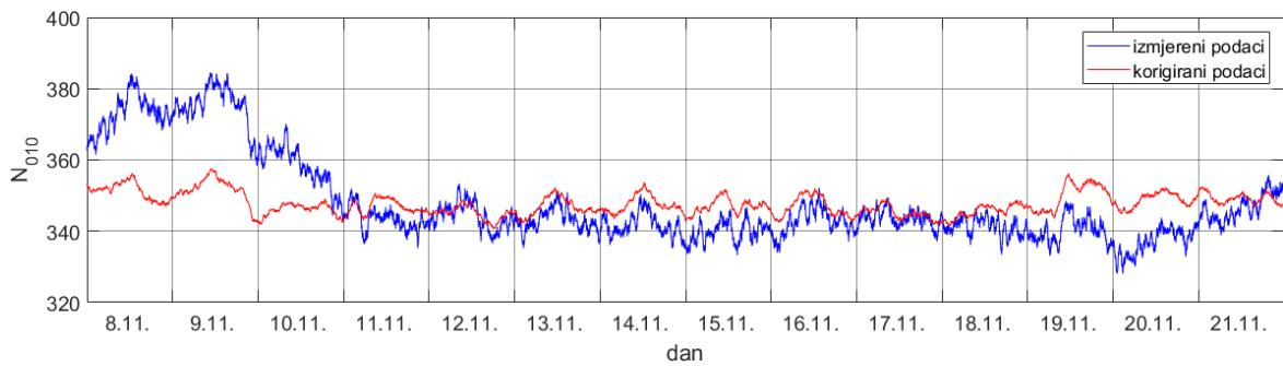
Slika 29. Grafovi izmjereno (plavo) i korigirano (crveno) intenziteta zračenja za dvotjedni period od 8.11.2010. do 21.11.2010. za kombinaciju 010 (neutralne čestice).
