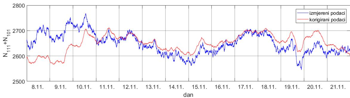
Slika 30. Grafovi izmjereno (plavo) i korigirano (crveno) intenziteta zračenja za dvotjedni period od 8.11.2010. do 21.11.2010. za kombinacije 111 i 101 (mioni visoke energije).
