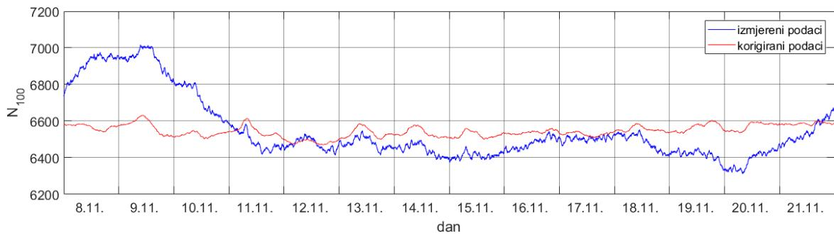
Slika 28. Grafovi izmjereno (plavo) i korigirano (crveno) intenziteta zračenja za dvotjedni period od 8.11.2010. do 21.11.2010. za kombinaciju 100 (nabijene čestice niske energije).
