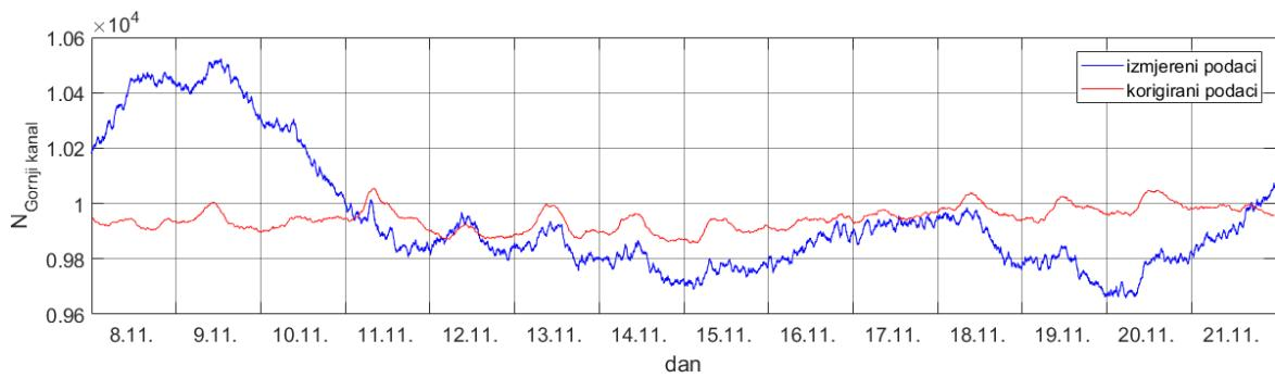
Slika 25. Grafovi izmjereno (plavo) i korigiranog (crveno) intenziteta zračenja za dvotjedni period od 8.11.2010. do 21.11.2010. za gornji kanal detektora.
