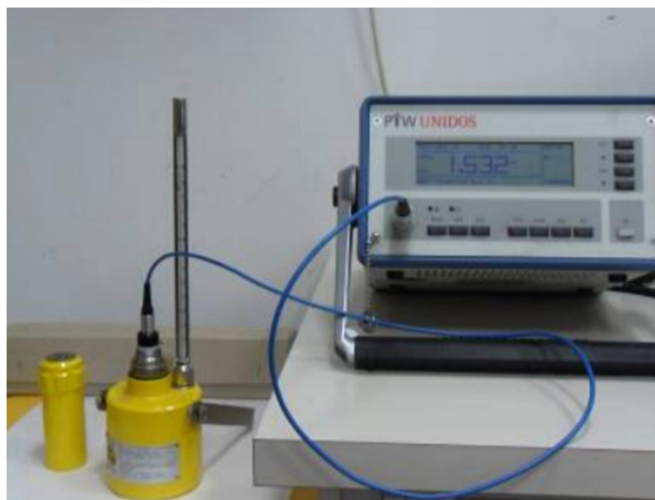
Slika 3.14. Postav za ispitivanje stabilnosti dozimetrijskog sustava koristeći radioaktivni izvor Sr-90.
