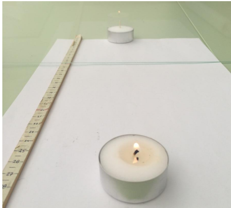
Slika 2.5: Pokus s dvije svijeće i staklom – samo je jedna svijeća upaljena, ali sada se ne čini se kao da obje svijeće gore jer su svijeće na različitim udaljenostima od stakla
