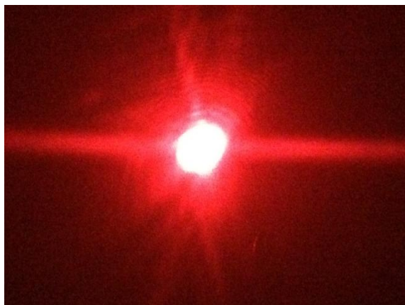
Slika 3.8: Ogib svjetlosti na pukotini manjeg promjera
