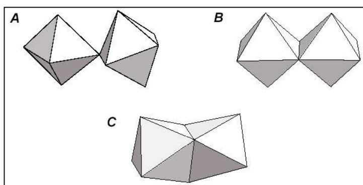
Slika 7. Poliedarski modeli koriste se za prikazivanje mogućih načina povezivanja osnovnih oktaedarskih  $MO_x$  jedinica u spojevima polioksometalata. Oktaedarske se jedinice mogu povezivati: vrhovima (A), bridovima (B) ili stranicama (C).
