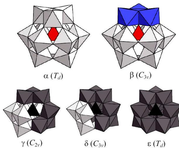
Slika 11. Prikaz Kegginovih  $\beta$ ,  $\gamma$ ,  $\delta$  ili  $\varepsilon$  izomera dobivenih rotacijom jedne, dviju, tri ili četiri  $\text{M}_3\text{O}_{13}$  strukturne jedinice
