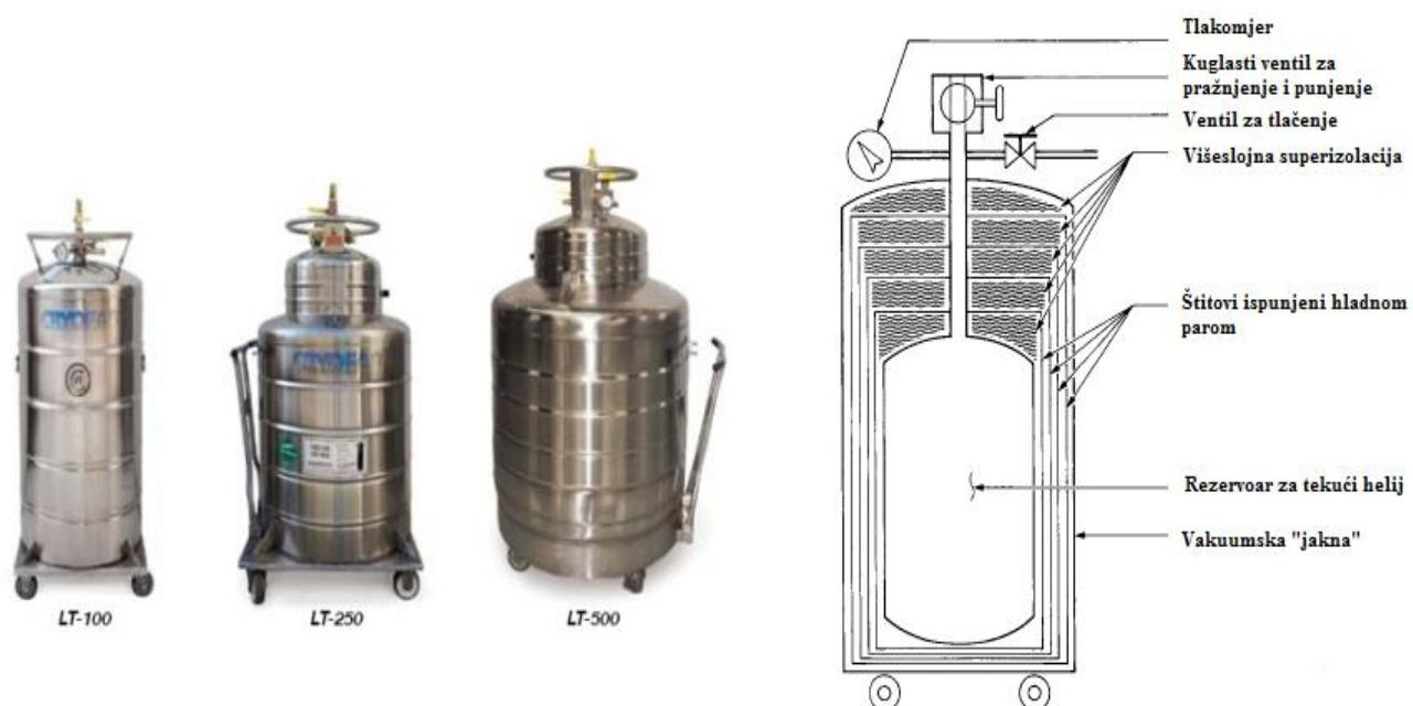
Slika 1. Nepropusni spremnici pod visokim tlakom za tekući helij s kapacitetom od 100 L, 250 L i 500 L. S desne strane slike nalazi se prikaz presjeka spremnika s njegovim dijelovima.<sup>5</sup>
