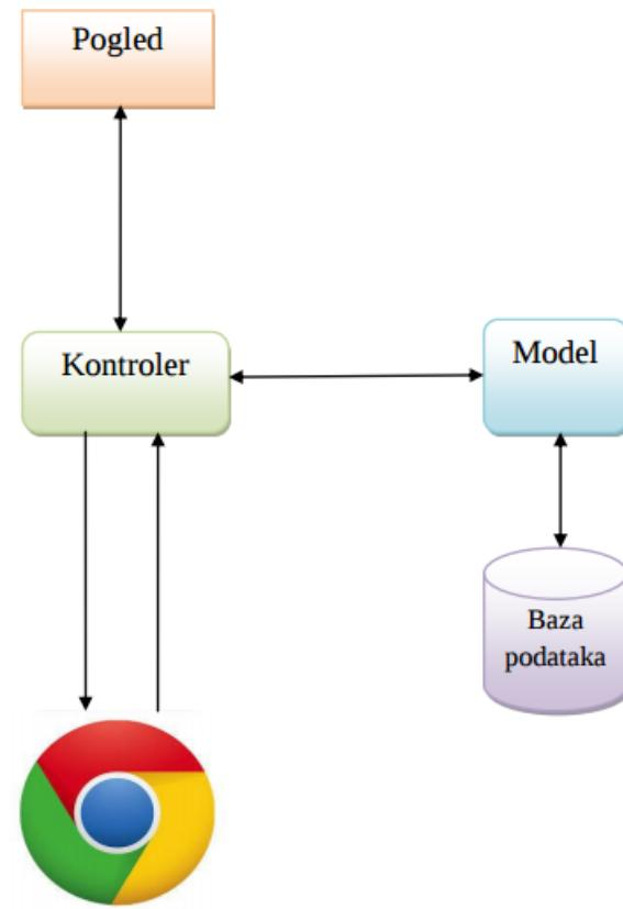
Slika 2.3: Shematski prikaz principa rada MVC arhitekture
