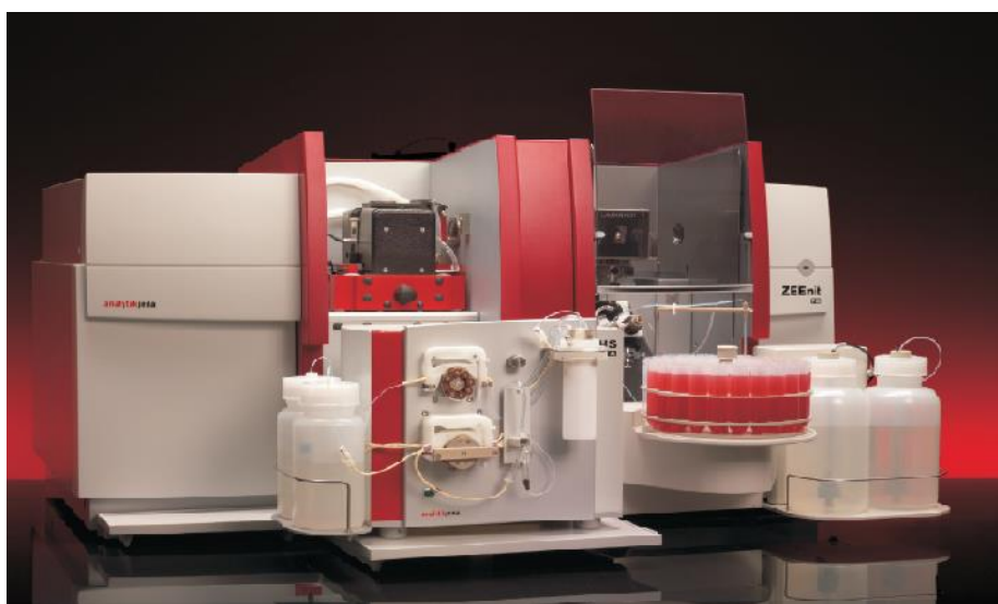
Slika 10: Instrumentacija tehnike HydrEA 23
