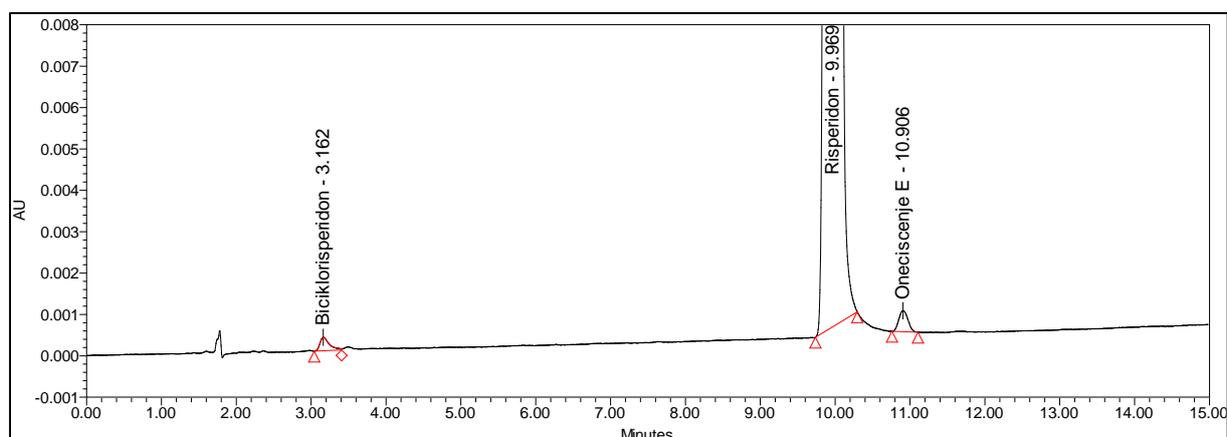
**Slika 9.** Kromatogram cijepljene otopine Risperidon aktivne supstancije za ispitivanje preciznosti metode
