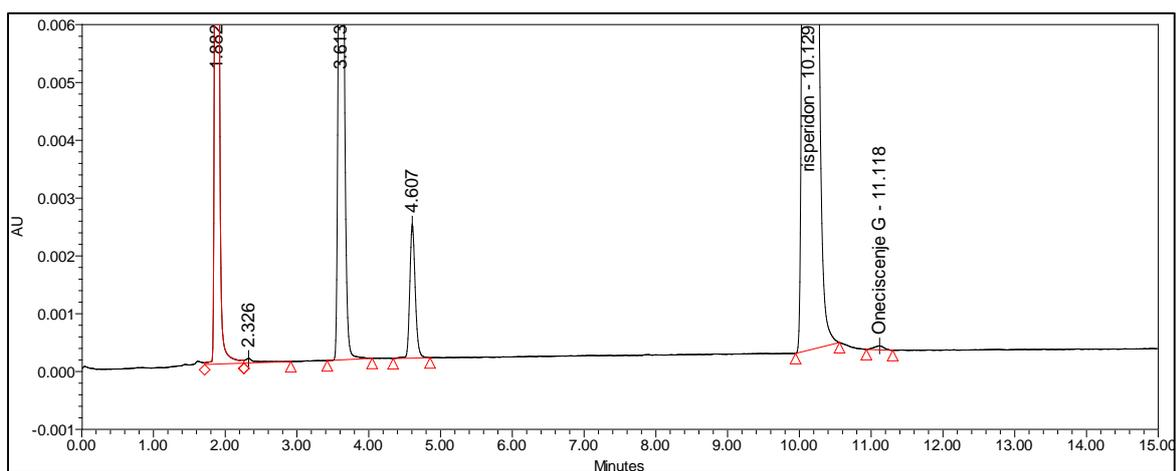
**Slika 10.** Uzorak risperidona razgrađen 3 % otopinom H<sub>2</sub>O<sub>2</sub> tijekom 24 h
