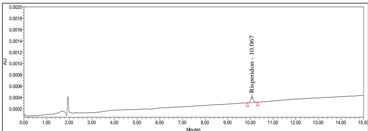
**Slika 7.** Kromatogram otopine za određivanje granice detekcije, otopina risperidona masene koncentracije 0,025  $\mu\text{g/mL}$  (0,025 % radne koncentracije uzorka)
