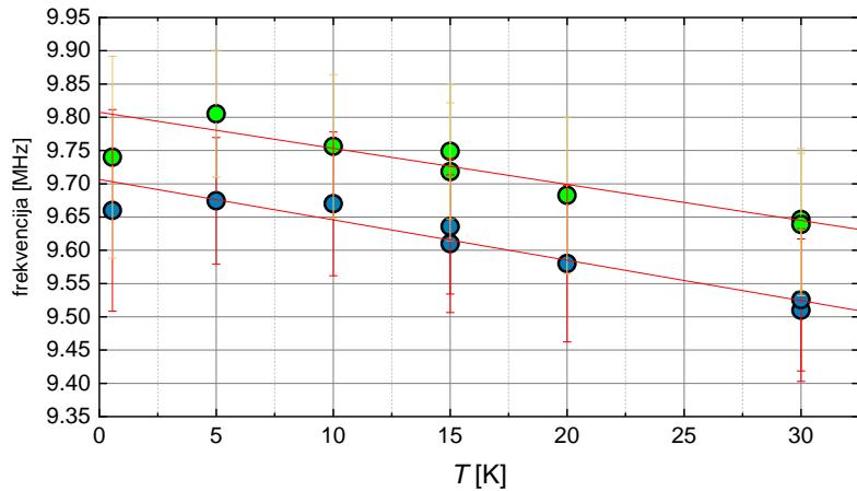
Slika 5.17: Temperaturna ovisnost frekvencija rezonancije za dva prijelaza ( $5/2 \rightarrow 3/2$ ,  $3/2 \rightarrow 1/2$ ) Pd(4a) jezgre prikazana na linearnoj skali; kao raspon pogreške uzeta je širina rezonancije na pola maksimuma (FWHM). Crvene linije prikazuju prepostavljenu linearnu ovisnost.
