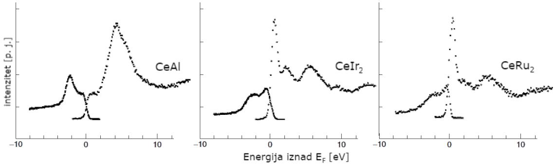
Slika 2.1: Spektar elektronskih stanja sustava s  $f$  elektronima dobiven (inverznom) rendgenskom fotoemisijskom spektroskopijom. Dok je pojava Kondove rezonancije u  $\text{CeIr}_2$  i  $\text{CeRu}_2$  jasno uočljiva, do nje ne dolazi u  $\text{CeAl}$  zbog uspostavljanja antiferomagnetskog uređenja. Preuzeto iz [14].
