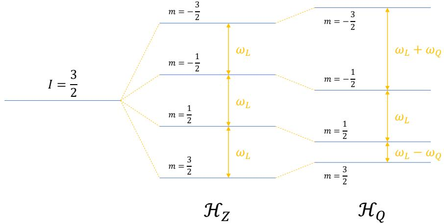
Slika 3.1: Vanjsko magnetsko polje otklanja degeneraciju spinskih stanja otvarajući  $N$  ekvidistantnih energetskih nivoa; kvadrupolno cijepanje dodatno utječe spektar spinskih stanja
