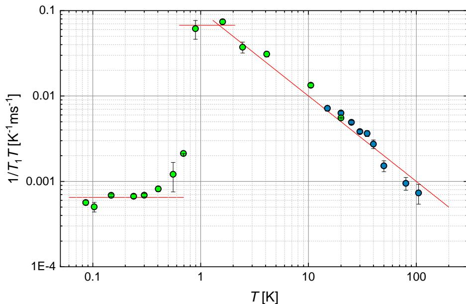
Slika 5.12: Temperaturna ovisnost  $(T_1 T)^{-1}$  za Pd(8c) sve do  $T = 86$  mK na logaritamskoj skali. Plave točke izmjerene su u Zagrebu, a zelene u Grenobleu. Crvena linija, koja na logaritamskoj skali prikazuje  $\propto T^{-1}$  ovisnost relaksacijskog vremena, dobivena je prilagodbom na visokotemperaturna mjerena ( $T > 1$  K).
