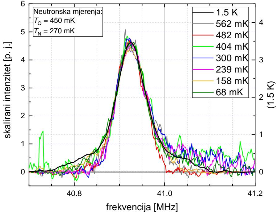
Slika 5.10: Preklopni NQR spektari CPS-a pri temperaturama od 68 mK do 1.5 K. Spektari mjerena od  $T = 68 \text{ mK}$  do  $T = 562 \text{ mK}$  skalirani su brojem akvizicija i temperaturom ( $I = T \cdot I_0/n_{\text{acq}}$ ), dok je spektar pri  $T = 1.5 \text{ K}$  (lijeva skala) skaliran proizvoljnim faktorom kako bi se dobilo podudaranje maksimuma intenziteta.
