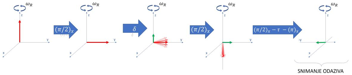
Slika 5.7: Impulsni slijed korišten za mjerjenje spin-rešetka relaksacijskog vremena ( $T_1$ .)
