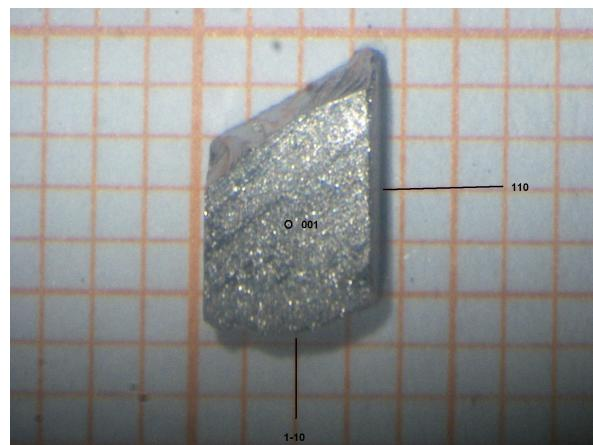
Slika 4.3: Uzorak CPS-a korišten za NQR mjerjenja pri  $f = 40$  MHz slikan na milimetarskom papiru (1 podjela  $\equiv 1$  mm) uz dočrtane oznake kristalografskih ravnina.
