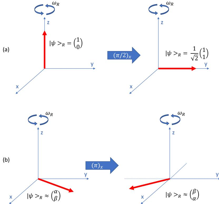
Slika 3.4: Prikaz rotacija u rotirajućem sustavu: (a) primjena  $(\pi/2)_x$  impulsa na početno stanje projekcije spina u bazi operatora  $\hat{I}_z$ ; (b) primjena  $(\pi)_x$  na neku proizvoljnu projekciju spina u  $x - y$  ravnini; strelica na  $z$  osi naznačava smjer Larmorove precesije u laboratorijskom sustavu.
