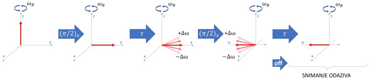
Slika 5.6: Impulsni slijed korišten za dobivanje NQR spektara uzorka.
