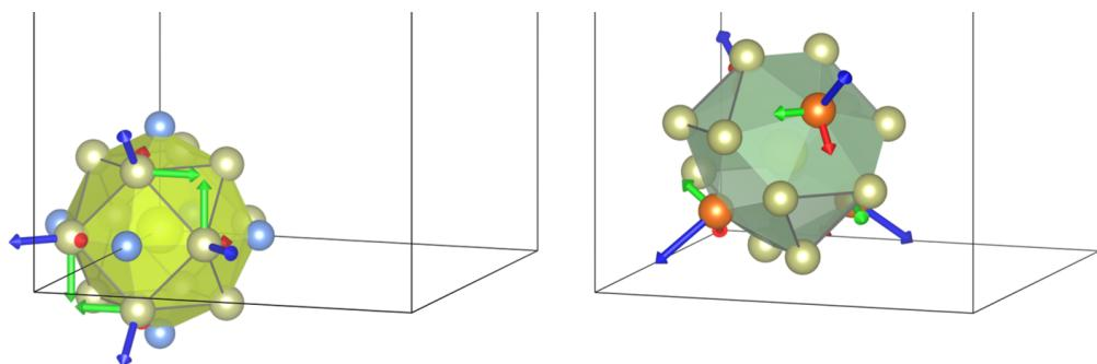
Slika 5.3: Grafički prikaz svojstvenih vektora EFG-a za dvije pozicije  $^{105}\text{Pd}$  različitih simetrija; magnitude vektora proporcionalne su svojstvenim vrijednostima tenzora EFG-a.
