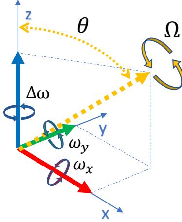
Slika 3.3: Skica reparametrisacije rotacija: magnitude vektora proporcionalne su kutnoj brzini rotacije. Sumiranje rotacija općenito nije komutativno; komutativnost vrijedi samo pri zbrajanju infinitezimalnih rotacija tj. brzina rotacija koje se odvijaju istovremeno.
