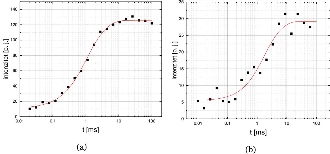
Slika 5.11: Utvrđivanje spin-rešetka relaksacijskog vremena prilagodbom modela (5.12) (crveno) na izmjerene i integrirane intenzitete rezonantnih spektara za  $n = 20$  različitim vremenima  $t$ . Prikaz mjerena za dvije različite temperature, 20 K (a) i 105 K (b), ukazuje na eksperimentalne poteškoće mjerena vremena relaksacije pri višim temperaturama (drastično pogoršanje signal-šum omjera).
