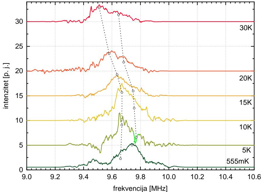
Slika 5.19: Promjena oblika rezonantne krivulje za Pd(4a); krivulje su skalirane s temperaturnim faktorom te su njihovi pomaci (y-offset) proporcionalni temperaturi. Prazni kružnici prikazuju pozicije maksimuma dobivenih prilagodbom Lorentzove krivulje na rezultate mjerjenja. Nedostatak signala (svijetlo zeleno) otežava interpretaciju rezultata pri  $T = 5$  K.
