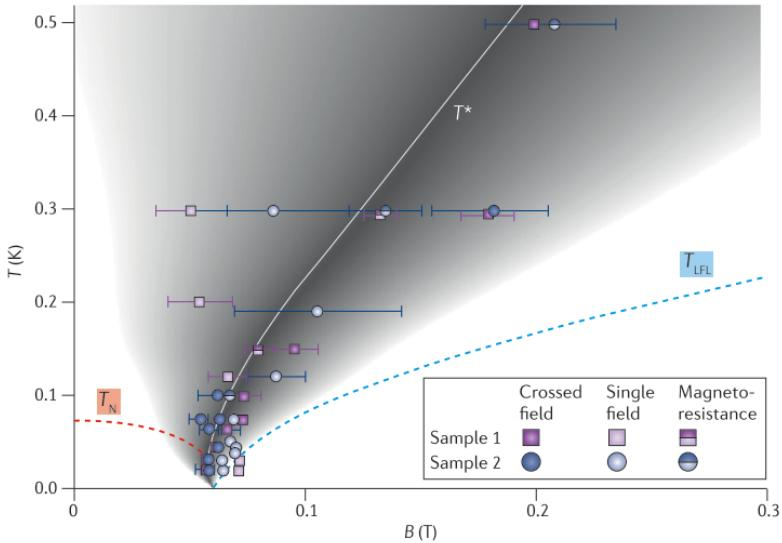
Slika 2.9: Fazni diagram  $\text{YbRh}_2\text{Si}_2$  sustava. Mjerenje Hallovog napona i magnetootpornosti za različite postavke i uzorke u blizini kritične temperature  $T^*$  (dobivena iz različitih T.D. mjerjenja) pokazuju prostiranje kvantno kritičnog stanja u okolini KKT-a. Oznake pokazuju magnetska polja pri kojima mjerene veličine pokazuju najjaču ovisnost o postavkama mjerjenja. Preuzeto iz [17].
