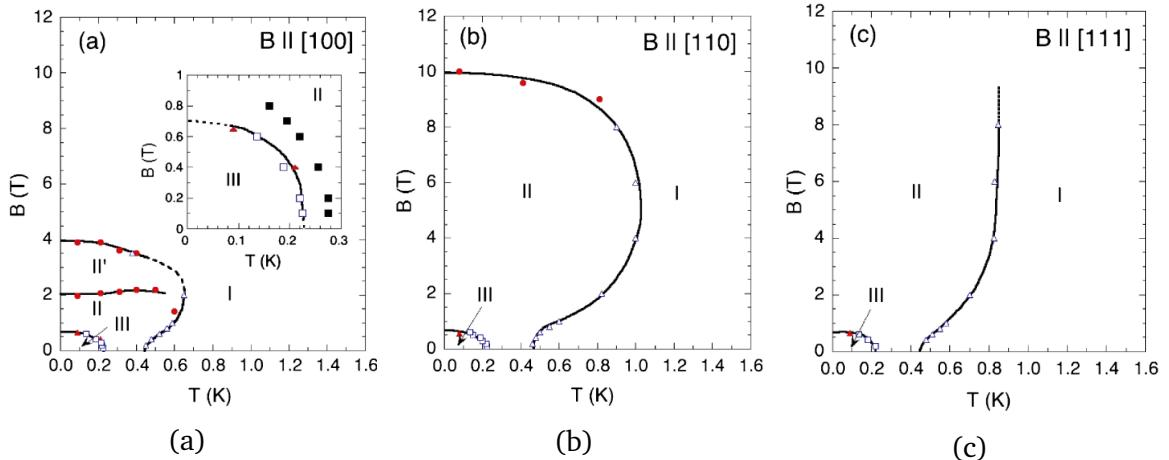
Slika 2.12: Fazni diagrami za CPS sustav dobiveni iz anomalnih ponašanja ili maksima magnetizacije za magnetska polja primjenjena u: (a) [100], (b) [110] i (c) [111] smjeru. Iz [43].
