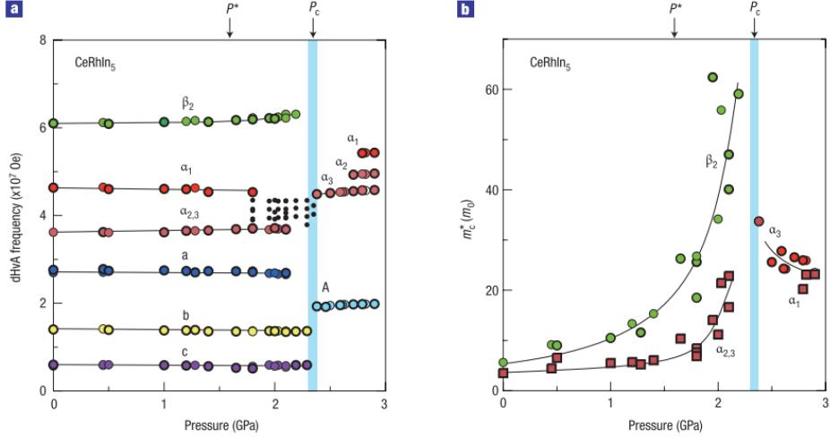
Slika 2.8: Promjena Fermijeve površine potvrđena je mjeranjem frekvencije dHvA oscilacija (a) te je popraćena divergencijom efektivne mase s obje strane KKT-a (b). Preuzeto iz [17].
