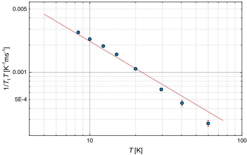
Slika 5.15: Temperaturna ovisnost  $T_1$  relaksacijskog vremena za  $^{29}\text{Si}$  ( $B = 12 \text{ T}$ , [100] smjer) u temperaturnom rasponu od 8.5 K do 60 K. Crvena linija prikazuje  $\propto T^{-1}$  ovisnost relaksacijskog vremena.
