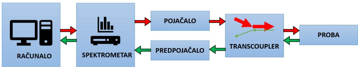
Slika 5.1: Shematski prikaz aparature za mjerjenje NMR/NQR spektara
