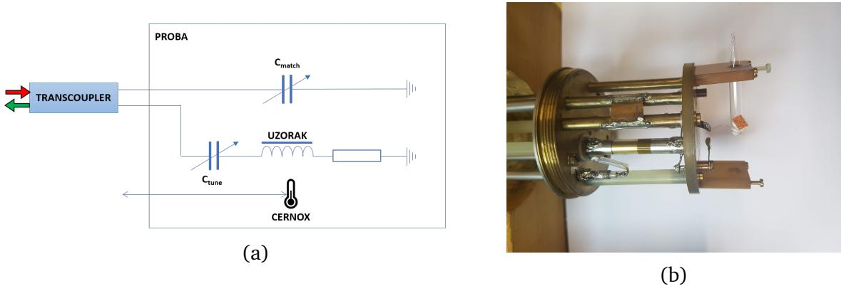
Slika 5.2: Shematski prikaz (a) i slika (b) izvedbe RLC kruga na nosaču uzorka; uzorak se nalazi pričvršćen unutar zavojnice (b).
