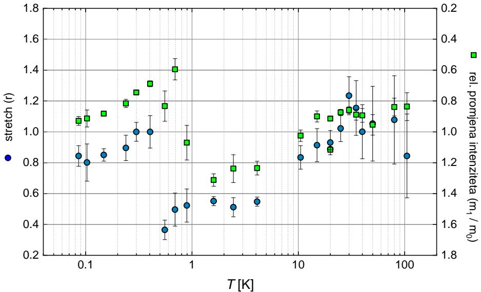
Slika 5.13: Temperaturna ovisnost  $r$  (stretch) parametra i omjera  $m_1$  i  $m_0$  parametara modela. Raspon pogreške dobiven je direktno iz računalne prilagodbe modela relaksacijske krivulje. Oba parametra,  $r$  i  $m_1/m_0$ , su jednaka 1 pri egzaktnom podudaranju s modelom.
