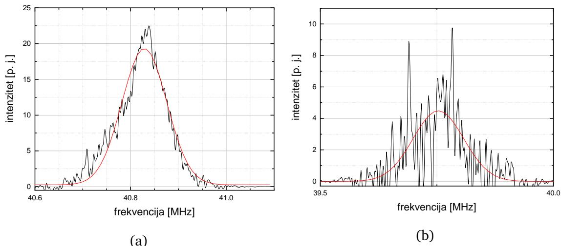
Slika 5.8: NQR spektri Pd(8c) jezgara snimljeni pri dvije različite temperature: (a) 20 K i (b) 200 K; rezonantna krivulja modelirana je gausijanom (crveno). Uočljivo je značajno pogoršanja signal-šum omjera pri višim temperaturama
