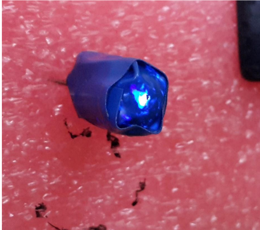
Slika 12. LED žarulja prekrivena izolacijskom ljepljivom trakom.
