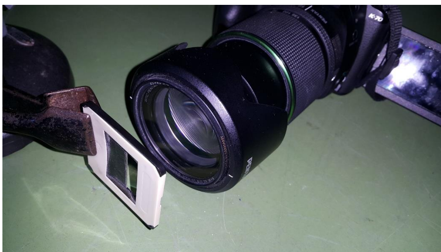
Slika 27. Kamera i žilet u ulozi oštrog ruba.
