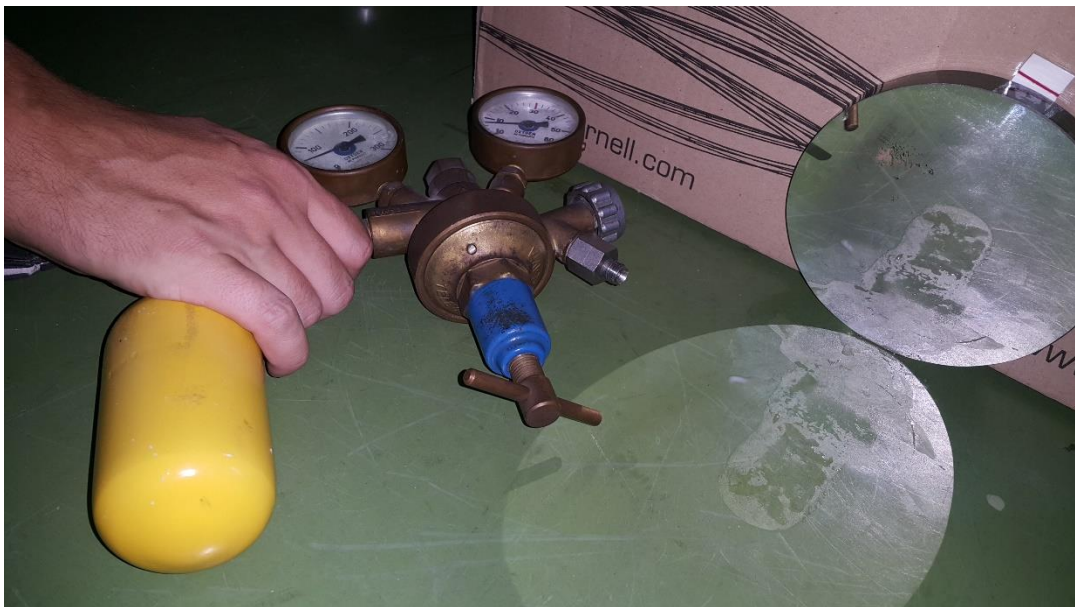
Slika 39. Puštanje helija iz boce pod tlakom (2).
