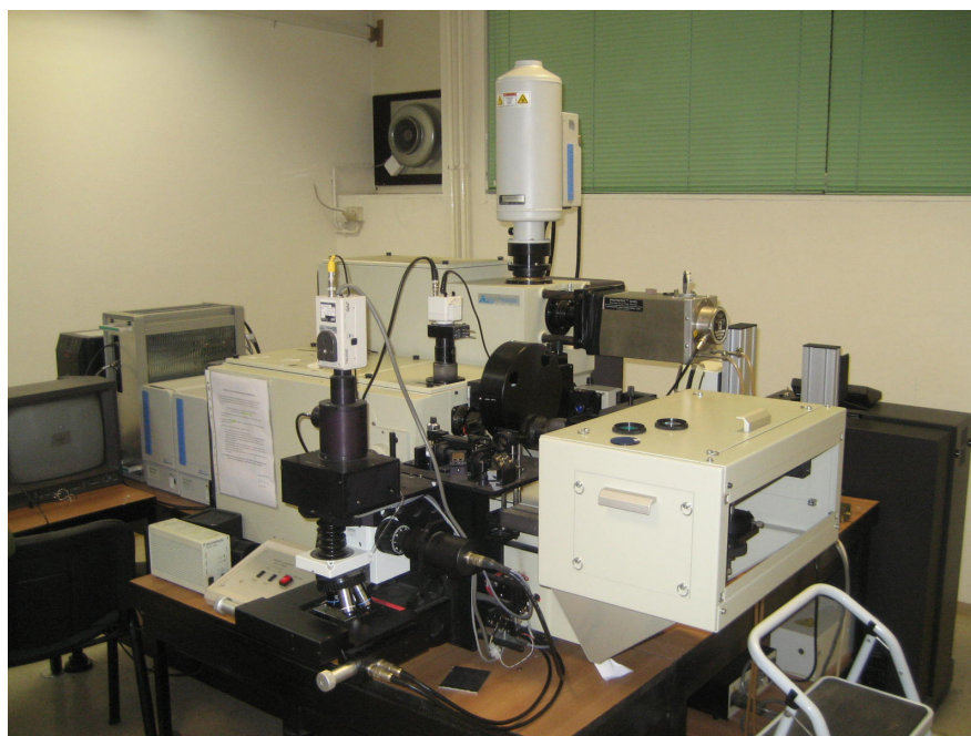
Slika 3.3: Ramanov spektrometar na Institutu Ruđer Bošković [27].
