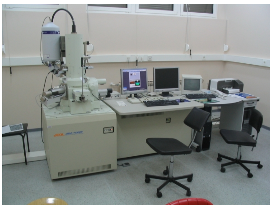
Slika 3.2: Skenirajući elektronski mikroskop na Institutu Ruđer Bošković [26].
