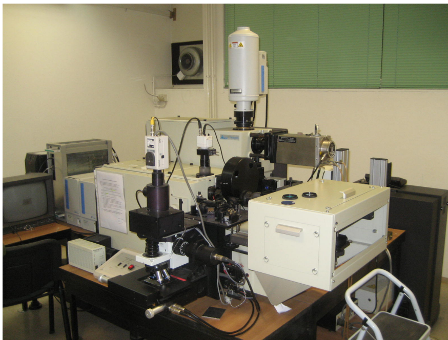
Slika 3.3: Ramanov spektrometar na Institutu Ruđer Bošković [27].
