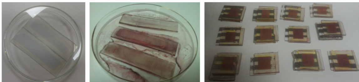
Slika 3.1: Lijevo: TiO 2 slojevi nanoseni na podloge FTO stakla, sredina: TiO 2 slojevi nakon umakanja u N3 boju, desno: sastavljene DSSC.
