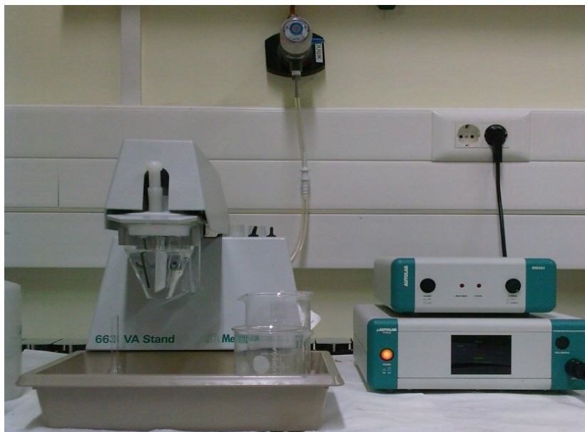
Slika 6. 663VA Stand troelektroдни sustav povezan s \mu AUTOLAB potencijostat/galvanostatom i IME jedinicom
