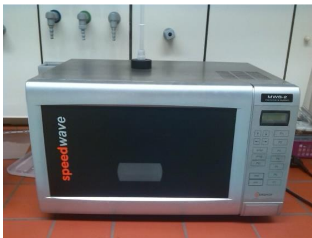
Slika 8. Sustav za mikrovalno razaranje
