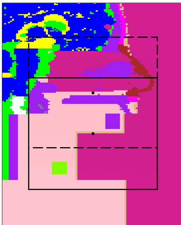
Slika 36. Najviši i najniži položaj FOV-a veličine 130 x 150 mm 2 . Crnim točkama označeno je središte FOV-a.
