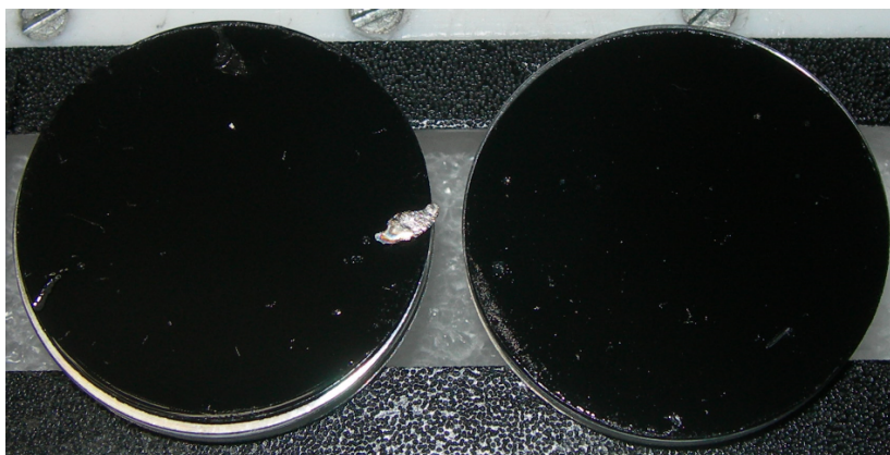
Slika 4.5: Čestice prašine iz JET-a na nosačima (stubovima).
