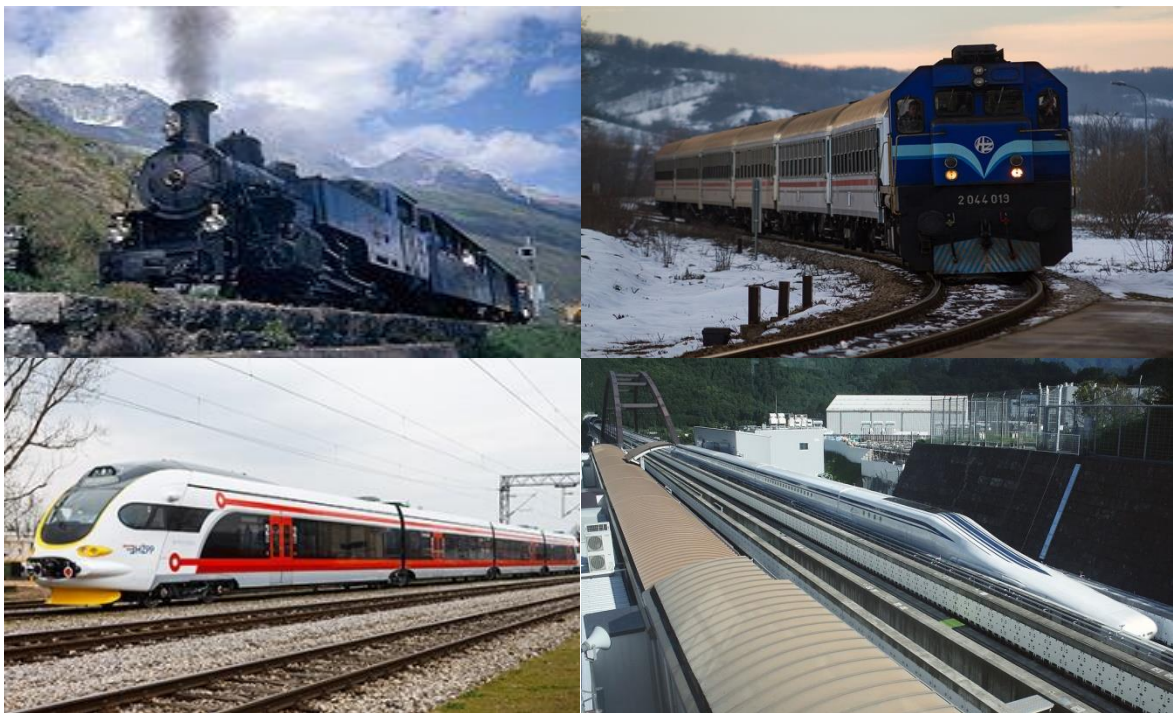
Slika 12. Usporedba različitih tipova vlakova: gore lijevo- vlak s parnom lokomotivom brzine do 40 km/h; gore desno- vlak s električnom lokomotivom brzine do 100 km/h; dolje lijevo- niskopodni vlak s elektromotornom lokomotivom brzine do 160 km/h; dolje desno- Maglev vlak brzine do 600 km/h
