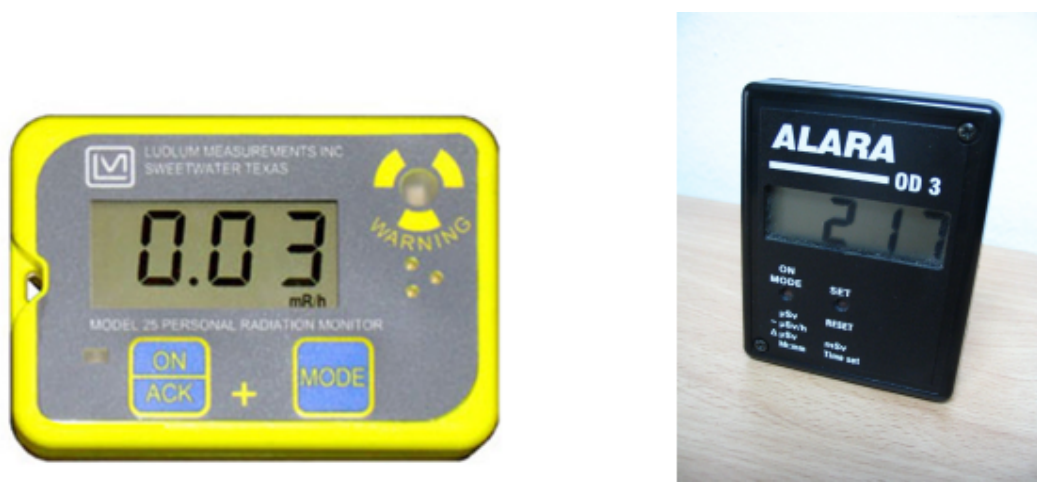
Slika 1.2: Aktivni elektronički dozimetri. [5]
