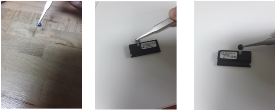
Slika 2.4: Postupak umetanja TL dozimetra u nosač za ozračivanje ili očitavanje.
