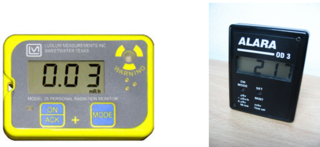
Slika 1.2: Aktivni elektronički dozimetri. [5]
