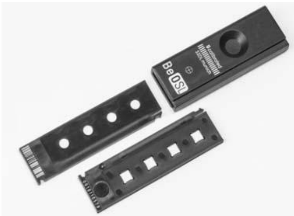
Slika 1.5: Dozimetar na bazi optički stimulirane luminiscencije. [7]
