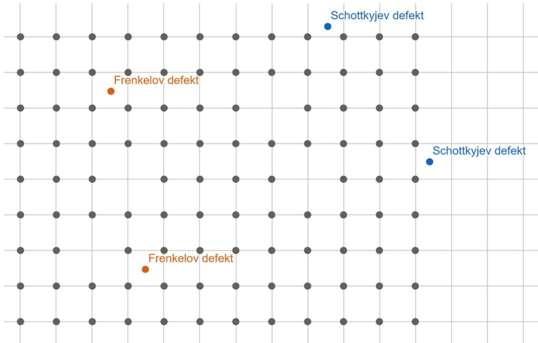
Slika 48 - prikaz Schottkyjevog i Frenkelovog defekta u kristalima
