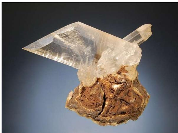
Slika 42 - Slika kristala gipsa, kalcijev-sulfat dihidrat ( $\text{CaSO}_4 \cdot 2\text{H}_2\text{O}$ )<sup>14</sup>
