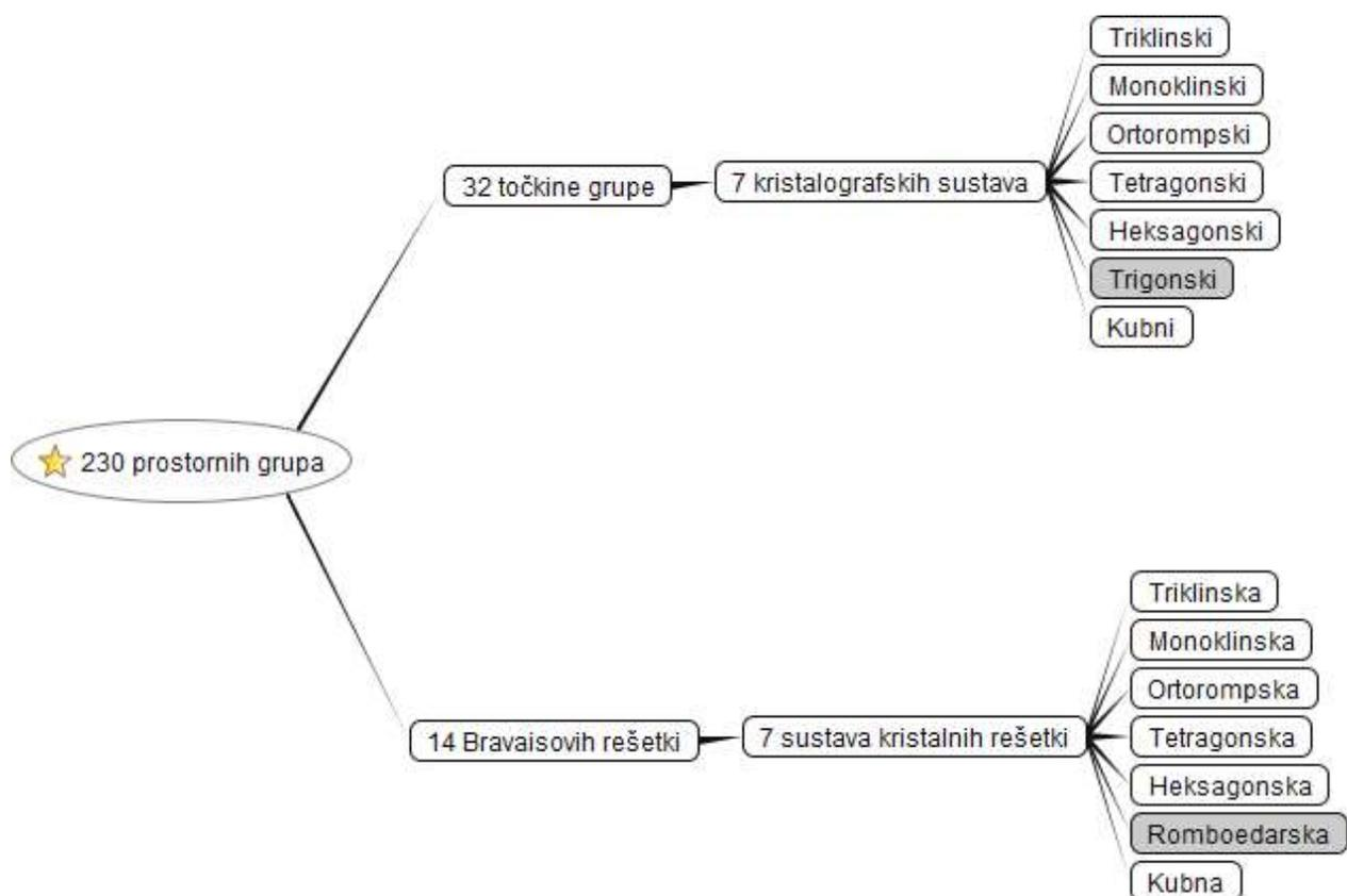
Slika 16 – prikaz povezanosti kristalografskih rešetki sa kristalografskim sustavima
