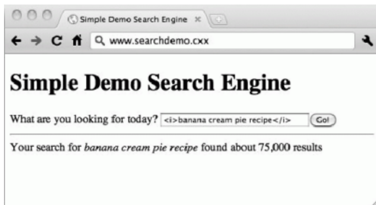
Slika 2.8: Primjer web tražilice s XSS propustom
