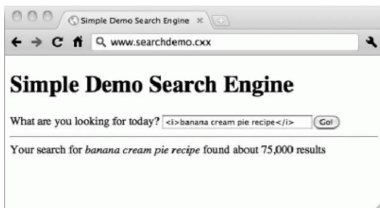
Slika 2.8: Primjer web tražilice s XSS propustom
