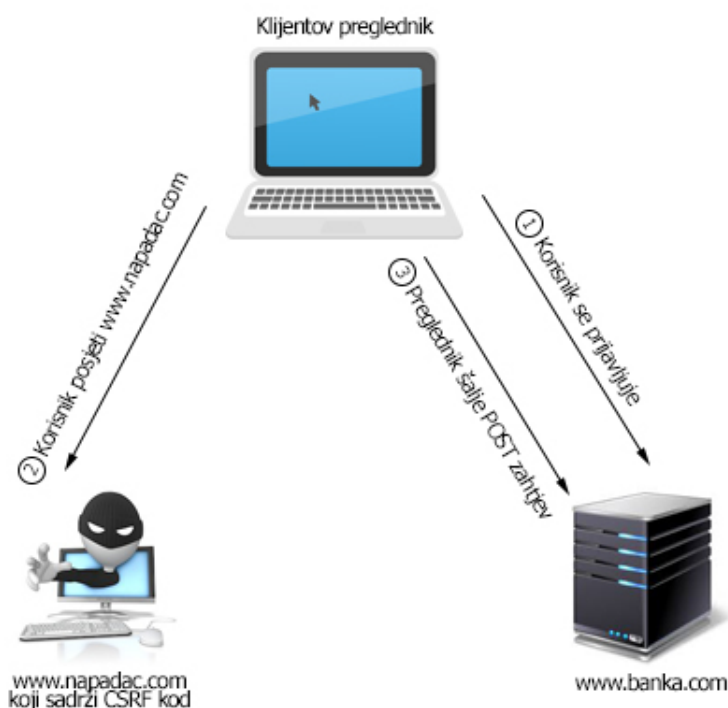
Slika 2.11: Jednostavan primjer CSRF napada
