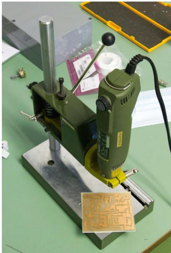
Slika 12 – Bušenje pločice
