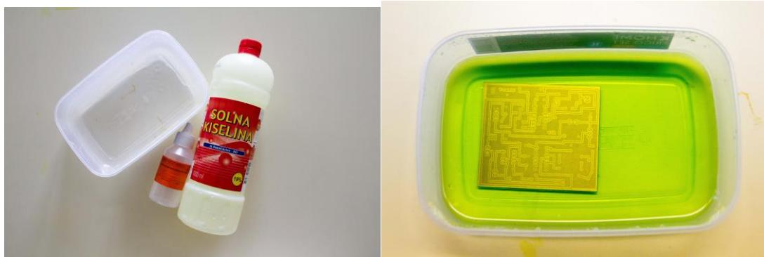
Slika 9 i 10 – Razvijanje pločice u otopini
