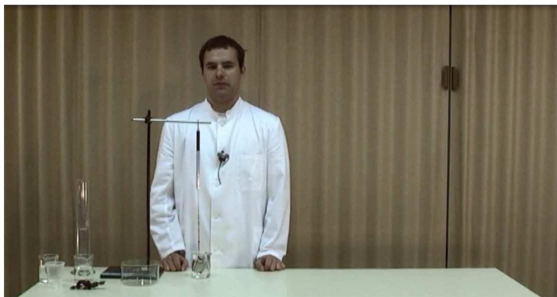
Dinamometar pokazuje manji iznos sile kao da se težina smanjila odnosno dinamometar je pokazivao silu od 4,3 N. S obzirom da je težina definirana kao umnožak mase i gravitacijskog ubrzanja, a u našem se slučaju niti masa niti gravitacijsko ubrzanje nisu mijenjali, zaključili smo da se uranjanjem utega u tekućinu pojavila dodatna sila.
