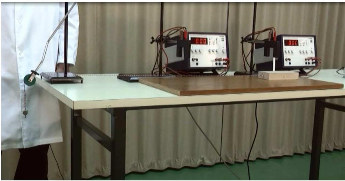
Dodajući još jedan uteg sila je uvećana za dvostruko no kvadar i dalje miruje pa zaključujemo da je statička sila trenja jednaka iznosu sila utega. Ni dodavanjem trećega utega kvadar se ne miče. Tek dodavanjem četvrtog utega kvadar se počinje gibati što znači da smo uspjeli nadvladati maksimalnu silu statičkog trenja.
