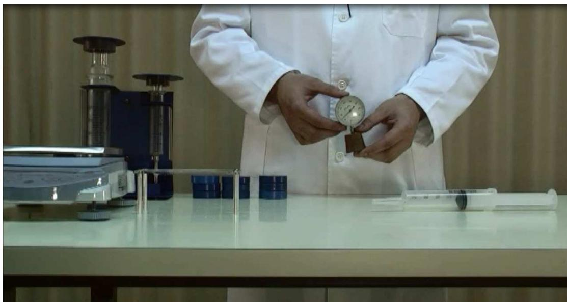
Postavljanjem njegove mjerne skale na nulu možemo pomoći njega mjeriti promjene tlaka. Izvlačenjem klipa iz brizgalice kroz rupicu usišemo okolni zrak. S obzirom da zrak može slobodno ulaziti i izlaziti iz brizgalice, tlak na unutarnjim stjenkama brizgalice je jednak tlaku koji djeluje na vanjske stjenke i ostale predmete koji se nalaze u blizini, odnosno unutar brizgalice imamo također atmosferski tlak.
