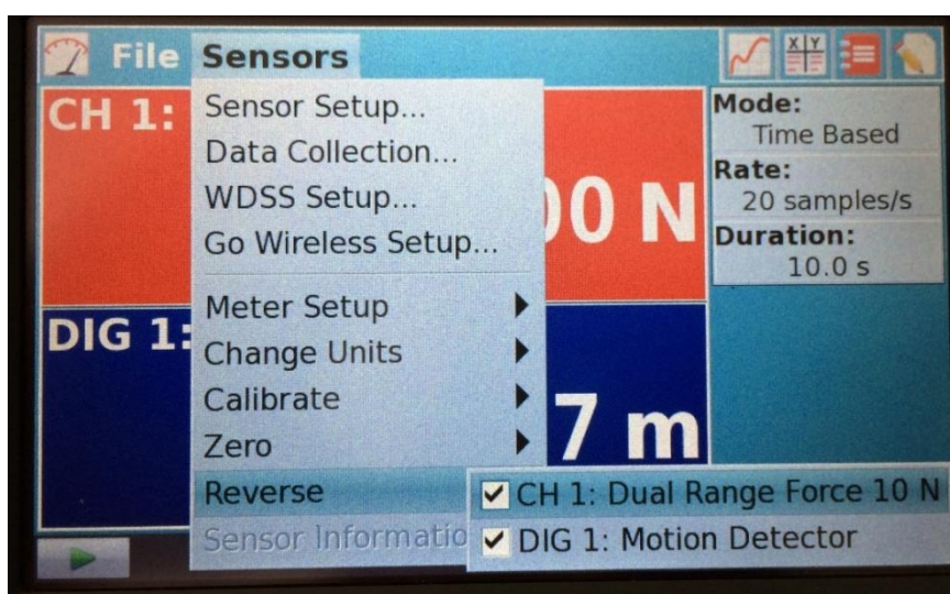
Slika 4.13: Prikaz okretanja pozitivnih smjerova mjerenja sile i položaja na računalu
