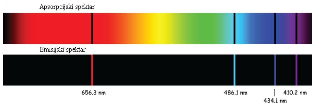
Slika 7: Apsorpcijski i emisijski spektri atoma vodika, preuzeto sa [7]
