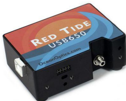
Slika 22: Korišteni Red Tide USB650 USB spektrometar tvrtke Ocean Optics, preuzeto iz [18]
