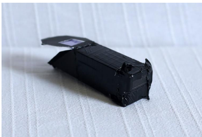
Slika 42: Spektrometar nakon sastavljanja - prednja strana
