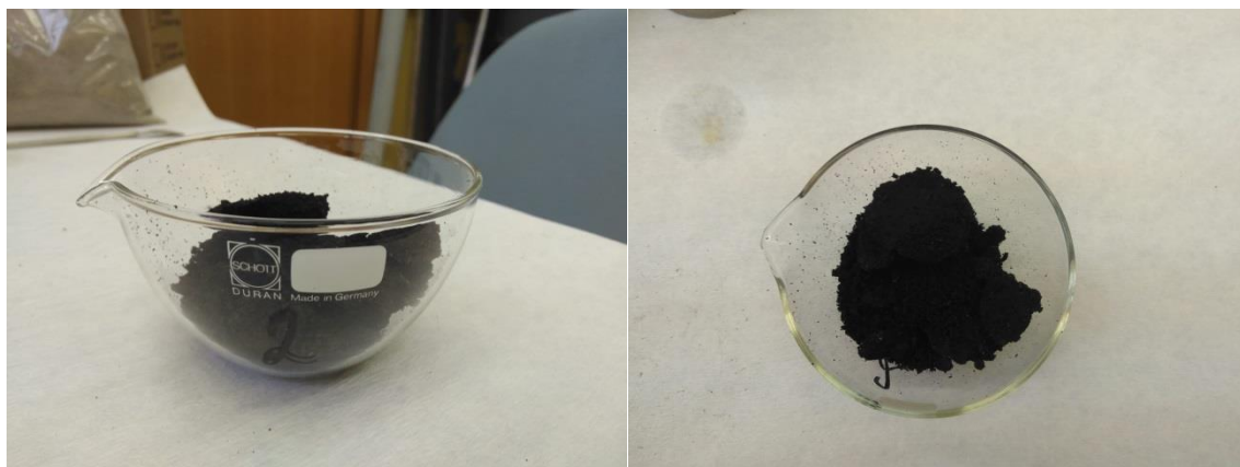
Slika 8: Geopolimer 2 nakon sušenja u labaratorijskoj pećnici 24h
