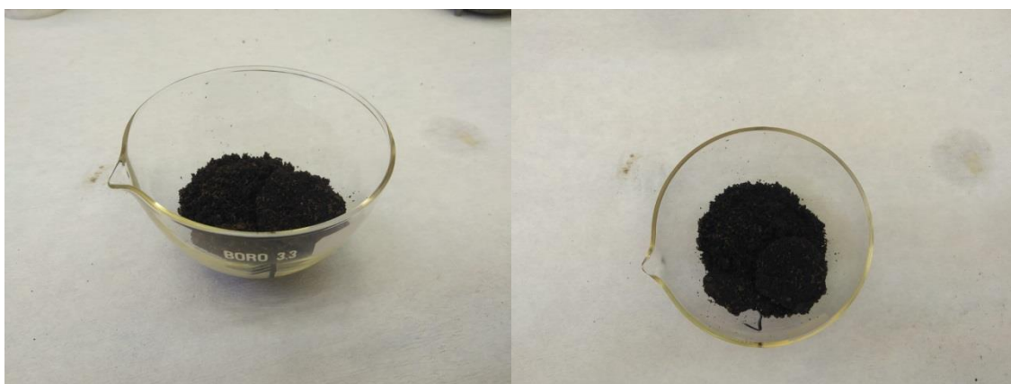
Slika 7: Geopolimer 1 nakon sušenja u labaratorijskoj pećnici 24 h
