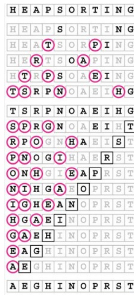
Slika 1.3: Primjer rada heapsort algoritma u mjestu. Prvi dio algoritma je pretvaranje niza u hrpu, dok je u drugom dijelu algoritma, crnim obrubom označen maksimalni element izbačen iz hrpe u tom koraku.
