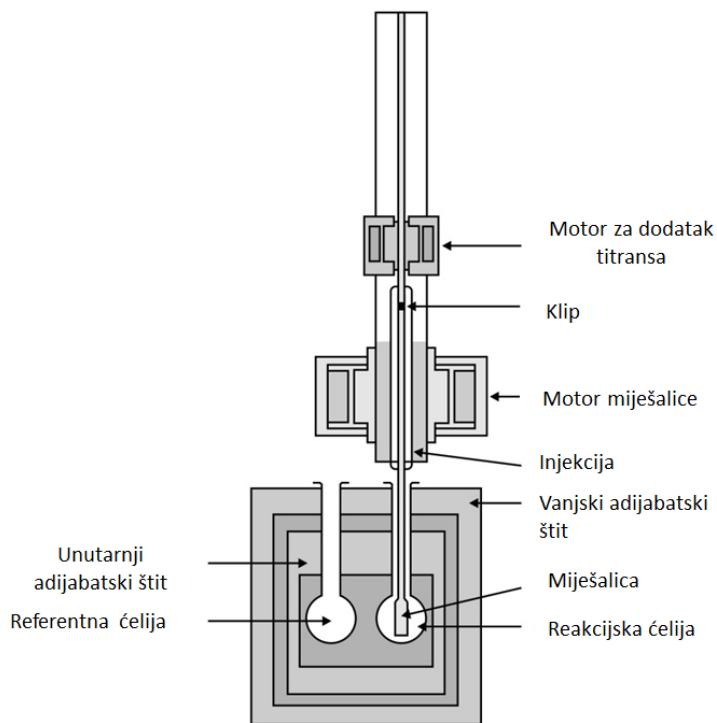
Slika 9. Shematski prikaz kalorimetra za ITC.<sup>15</sup>
