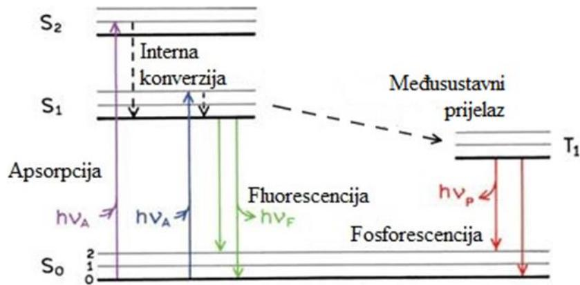
Slika 8. Dijagram Jablonskog. Radijativni prijelazi su prikazani punim strelicama, a neradijativni isprekidanim (S<sub>0</sub>-osnovno singletno stanje, S<sub>1</sub> i S<sub>2</sub>- pobuđena stanja istog multipliciteta, T<sub>1</sub>- najniže tripletno stanje).<sup>24</sup>
