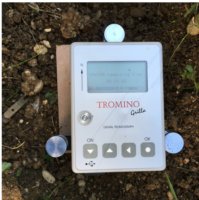
Slika 5.1: Tromino, uređaj za mjerenje seizmičkog nemira
