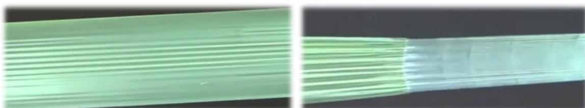
Slika M22. Jednoliko rastezanje prve vrpce (lijevo); nejednoliko rastezanje treće vrpce (desno).<sup>21</sup>
