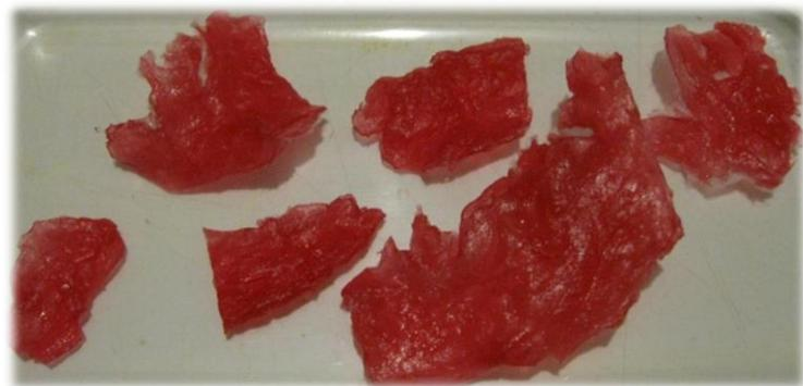
**Slika M21.** Uzorci bioplastike na bazi škroba.
