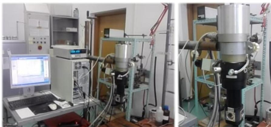
Slika 27. Aparatura za kriogene eksperimente.
