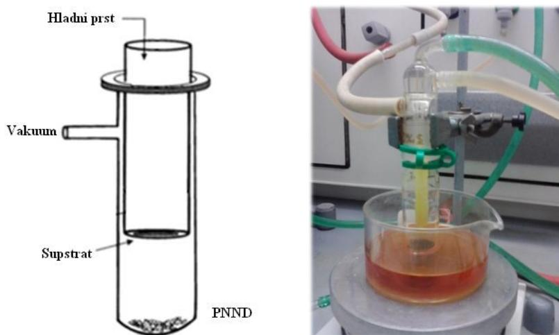
Slika 26. Skica aparature za izolaciju čistog PNND sublimacijom pri sniženom tlaku (lijevo). Fotografija aparature (desno).<sup>16</sup>
