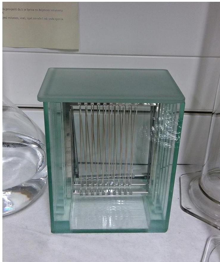
Slika 16. Kromarode u komori od kvarcnog stakla s poklopcem
