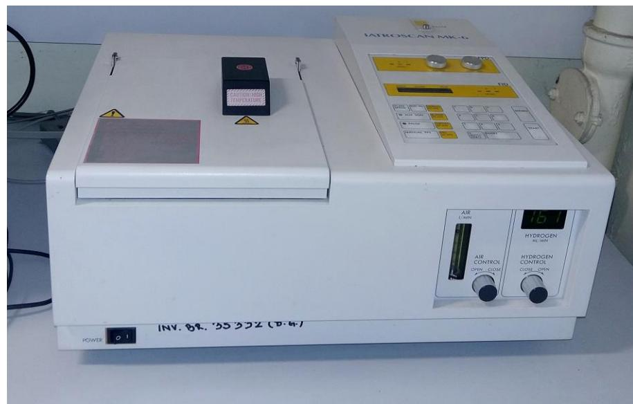
Slika 14. Instrument za analizu lipida, IATROSCAN MK-6
