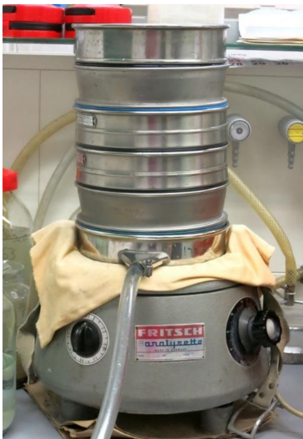
Slika 8. Set Retsch® ASTM sita, Geološko-paleontološki zavod PMF-a Pikelj (2018)
