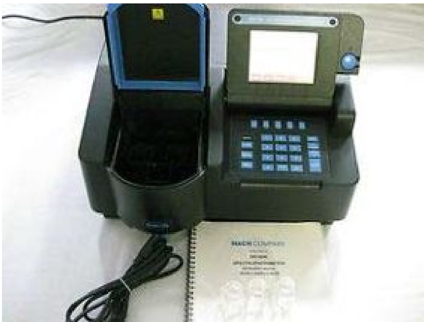
Slika 10 Spektrofotometar HACH DR/4000.
