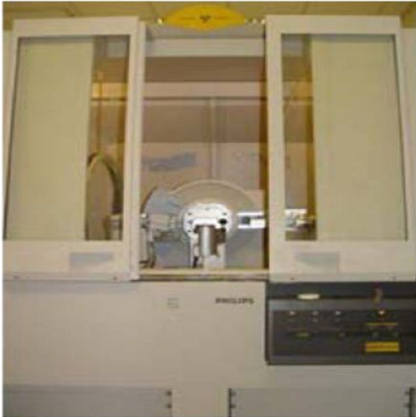
Slika 14. Rendgenski difraktometar Philips PW3040/60 X'Pert Pro. Mineraloško-petrografski zavod.
