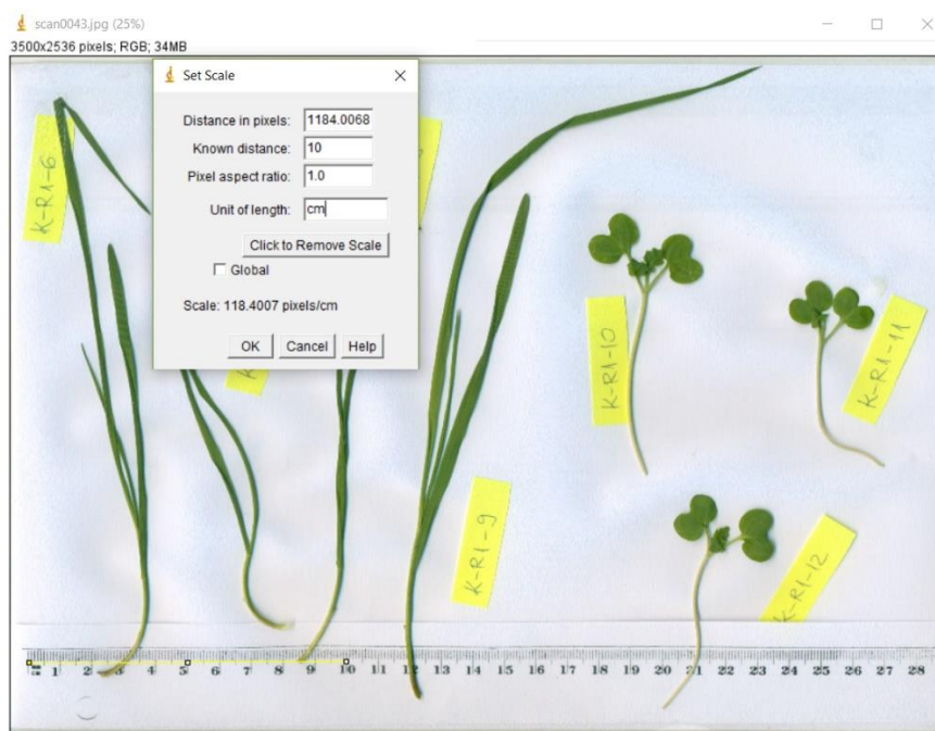
Slika 10. Namještanje mjerne skale u programu ImageJ na primjeru jedne fotografije nastale skeniranjem za mjerenje duljine nadzemnih dijelova klijanaca
