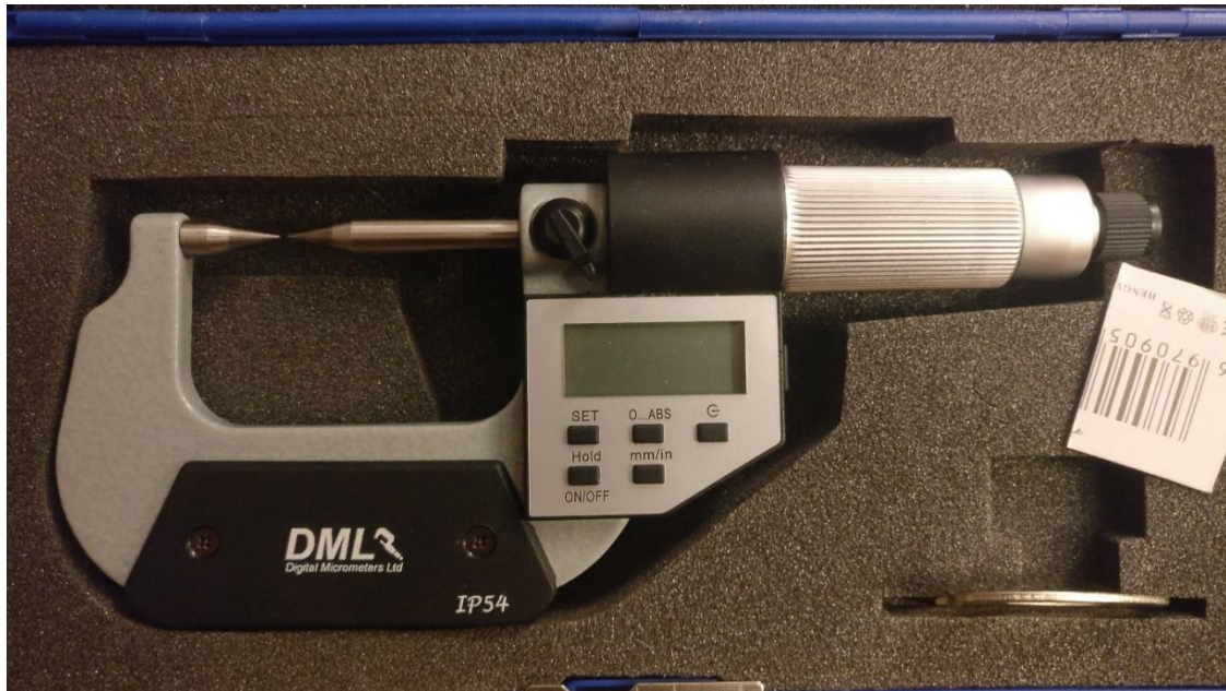
Slika 19. Mikrometar korišten za mjerenje širine glave jedinki Sympetrum fonscolombi .
