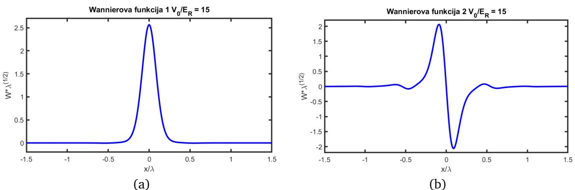
Slika 2.6: Maksimalno lokalizirane Wannierove funkcije definirane oko točke  $x_i = 0$  za prve dvije najniže vrpce. Dubina potencijala rešetke je  $V_0/E_R = 15$ . S porastom dubine potencijala funkcije brže trnu s udaljenosti od čvora  $x_i$ . Za više vrpce ovisnost o dubini potencijala je manja.
