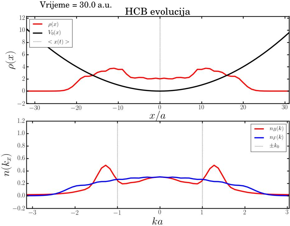
Slika 3.6: Gornji dio slike prikazuje harmonički potencijal  $V(x) = V_0 x^2$  s  $V_0 = 0.01$ , raspodjelu gustoće čestica i očekivani položaj čestica  $\langle x(t) \rangle$  za broj čvorova  $M = 64$  i broj čestica  $N = 11$  u trenutku  $\tau = 30.0$ . Na donjoj slici su prikazane raspodjele količine gibanja za neinteragirajuće fermione  $n_F$  i HCB bozona  $n_k$ . Parametar pre-skakanja između čvorova je  $J = 0.252$ .
