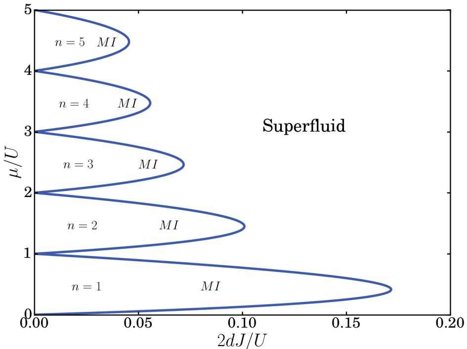
Slika 3.1: Fazni dijagram u aproksimaciji srednjeg polja zadan jednadžbom (3.19). Unutar izbočenih dijelova sustav je Mottov izolator, dok je izvan njih superfluid.
