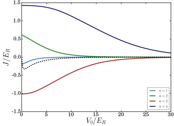
Slika 3.4: Parametar preskakanja između prvih susjeda za četiri najniže energijske vrpce u jedinicama  $E_R = \hbar^2\pi^2/2ma^2$  za potencijal  $V(x) = V_0 \cos(kx)$ . Crnom crtakom linijom je prikazan parametar preskakanja za najnižu vrpcu prema jednadžbi (3.25).
