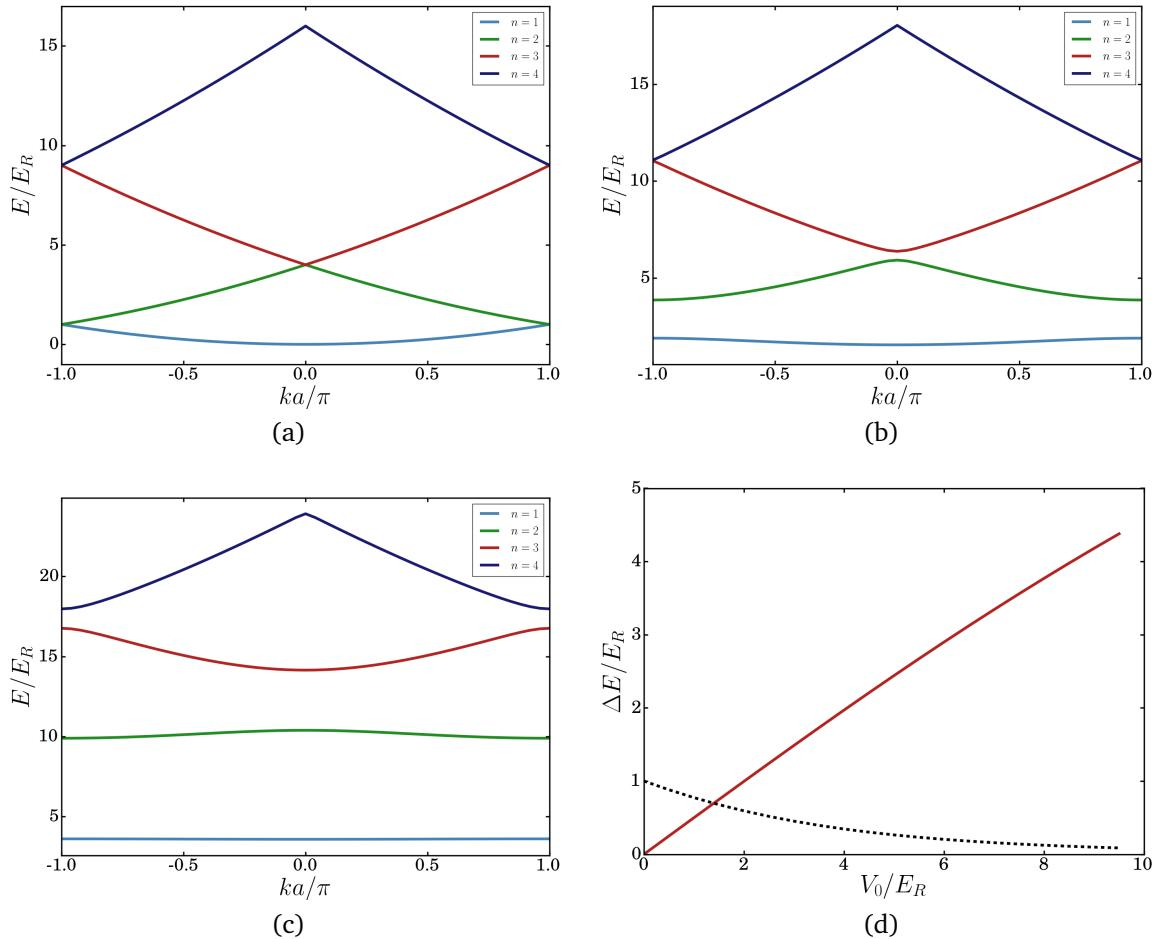
Slika 2.4: Energijeske vrpce za jednu česticu u periodičnom potencijalu  $V_L(x) = V_0 \sin^2(kx)$ . (a)  $V_0/E_R = 0$ , (b)  $V_0/E_R = 4$ , (c)  $V_0/E_R = 15$ . Na slici (d) je crnom crtkanom linijom prikazana širina najniže energijske vrpce, a crvenom linijom najmanji razmak između najniže i prve pobuđene vrpce.
