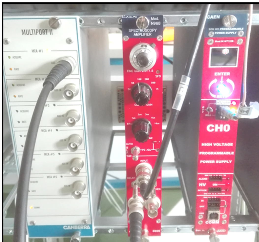
Slika 7.6: Glavni elektronički djelovi eksperimentanog postava; MCA, pojačalo i visoko detektorsko napajanje.
