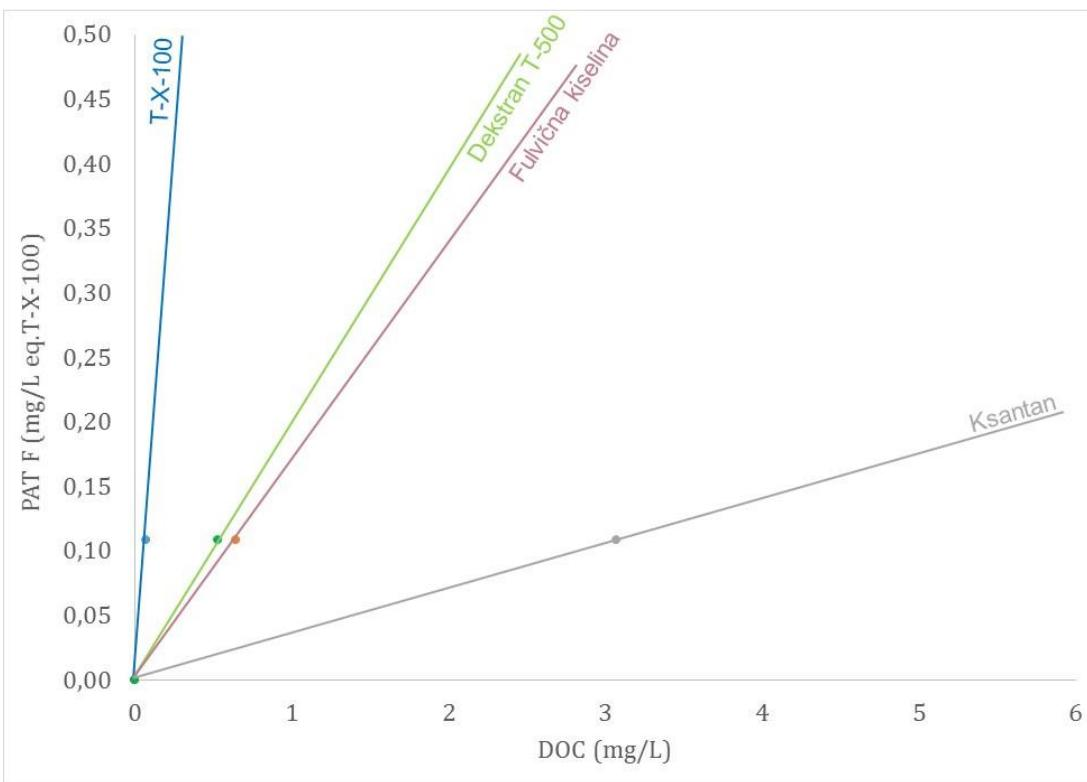
Slika 1. Normalizirana površinska aktivnost odabralih modelnih tvari relevantnih za tip materijala koji nalazimo u moru (triton X-100, dekstran T-500, fulvična kiselina, ksantan); modificirano iz Ćosović i Vojvodić (1998); NPA vrijednosti modelnih tvari: 1,54 T-X-100; 0,20 dekstran T-500; 0,17 fulvična kiselina; 0,04 ksantan
